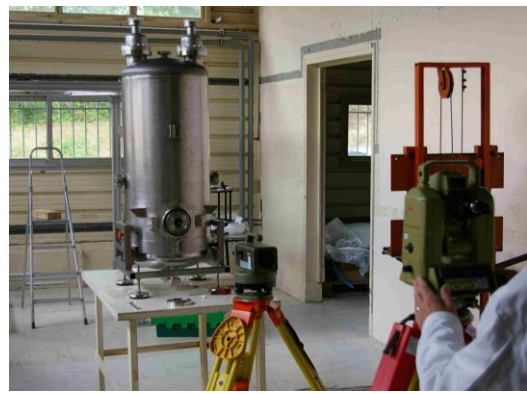
Figure 3-46 : (a) : Contrôle de l'alignement du tube faisceau. Visible dans l'ordre : piquage d'entrée, tube intérieur traversant la noix à l'extrémité du stem, piquage de sortie et mire de visée. (b) : Mesure du report d'axes entre le tube faisceau et les mires de visées.
