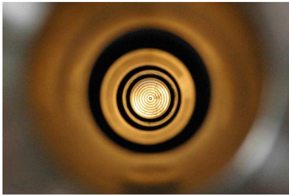
Figure 3-46 : (a) : Contrôle de l'alignement du tube faisceau. Visible dans l'ordre : piquage d'entrée, tube intérieur traversant la noix à l'extrémité du stem, piquage de sortie et mire de visée. (b) : Mesure du report d'axes entre le tube faisceau et les mires de visées.
