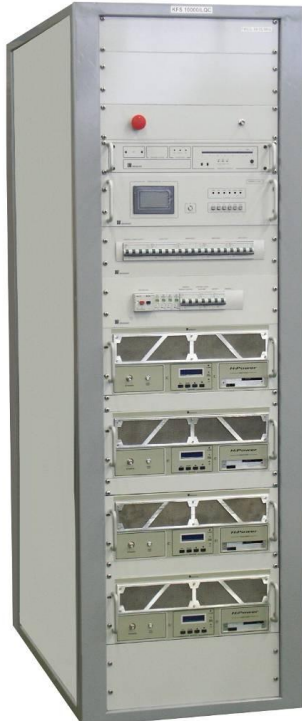
Figure 3-85 : (a) Photographie d'une baie d'un amplificateur 10 kWatts pour Spiral2. (b) Graphique représentant le gain (en dB) de l'amplificateur en fonction de la puissance de sortie (Watts). Le gain non constant est caractéristique des amplificateurs de classe C.
