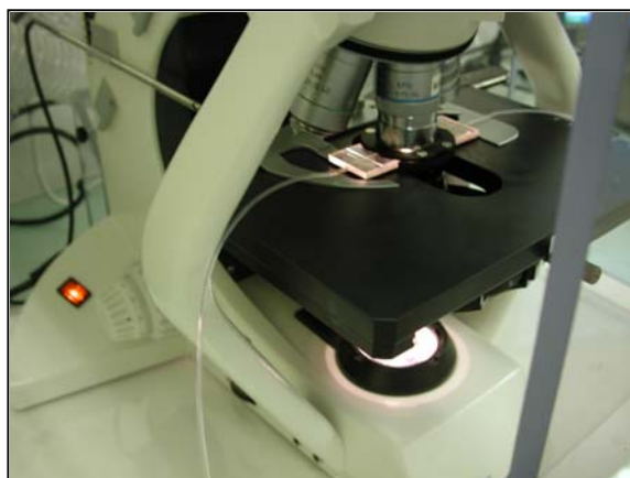
Figure 3-6. Chambre placée dans le RTM
