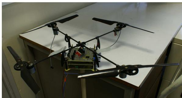
FIG. 3.3 – Quadrotor du projet *Safe-NECS*
