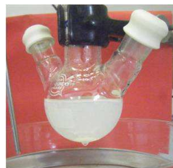
Fig. A.5.: Solution de particules avant et après la polymérisation. L'apparition d'une turbidité dans le sol de particules greffées de polymère est liée à la taille des objets (et pas à l'agrégation comme cela a été vérifié en DNPA).
