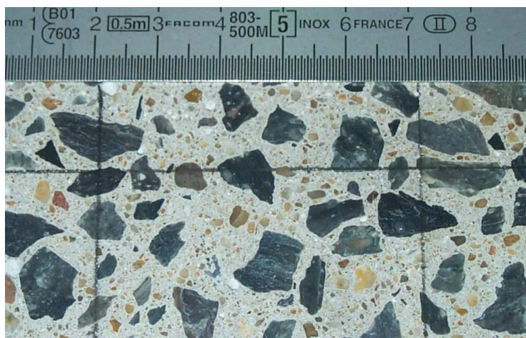
Figure 7.2: Coupe d'un béton (gris : mortier ; noir : graviers).
