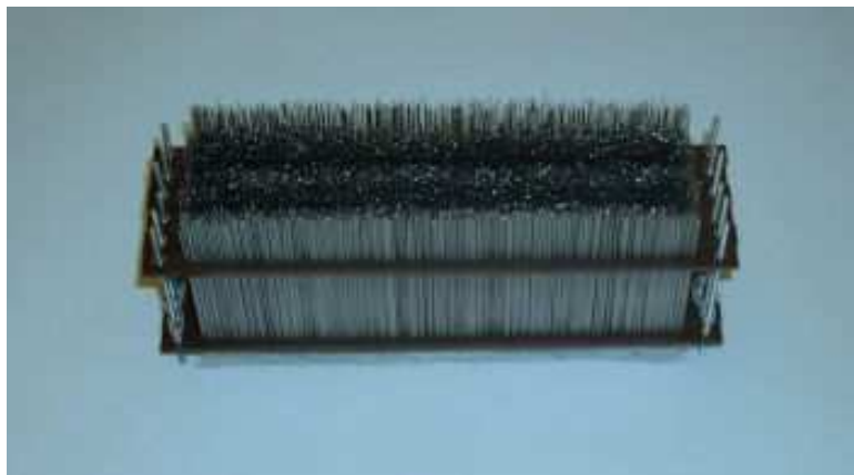
Figure 7.1: Echantillon de tiges d'aciers, issu de [113].
