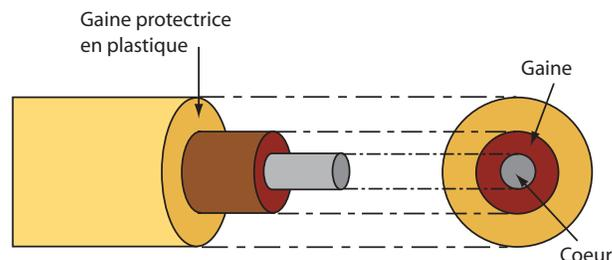
FIGURE 1.1 – Structure d'une fibre optique conventionnelle.
