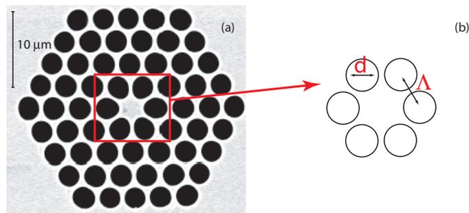
FIGURE 1.6 – (a) Coupe transversale d'une fibre microstructurée à cœur plein. Image réalisée avec un microscope à balayage électronique (MEB). (b) Schéma d'une structure courante, dite « en nid d'abeille », avec  $d$ , le diamètre des trous et  $\Lambda$  l'espacement entre les trous (*pitch* en anglais).
