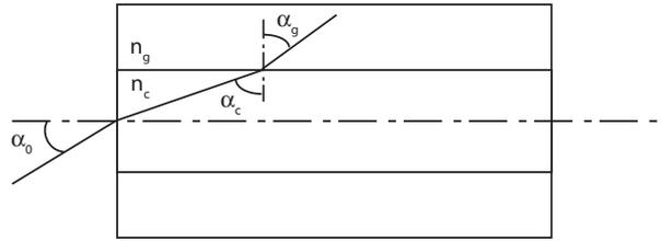
FIGURE 1.2 – Cône d'acceptance des faisceaux incidents.
