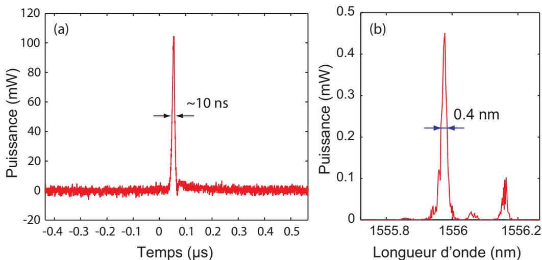
FIGURE 3.6 – (a) Trace temporelle enregistrée à la sortie du laser fibré impulsif sur l'oscilloscope. (b) Spectre du laser enregistré par l'analyseur de spectre optique.
