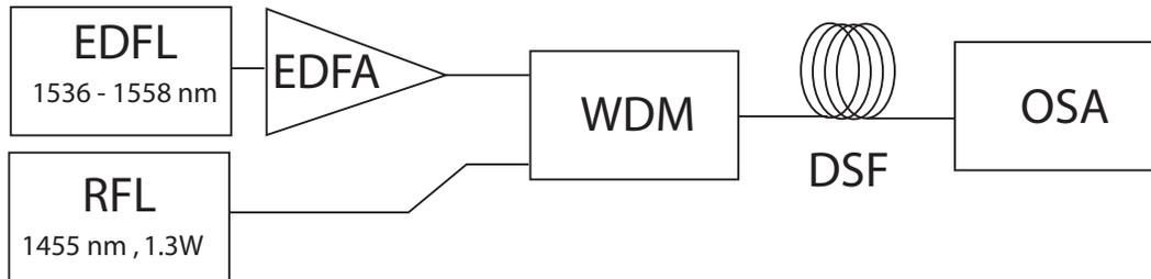
FIGURE 2.15 – Schéma de l'expérience. EDFL, *Erbium Doped Fiber Laser* : laser à fibre dopée Erbium, EDFA, *Erbium Doped Fiber Amplifier* : amplificateur à fibre dopée Erbium, RFL, *Raman Fiber Laser* : laser Raman à fibre, WDM, *Wavelength Division Multiplexer* : multiplexeur en longueurs d'onde, DSF, *Dispersion-Shifted Fiber* : fibre à dispersion décalée, OSA, *Optical Spectrum Analyzer* : analyseur de spectre optique.
