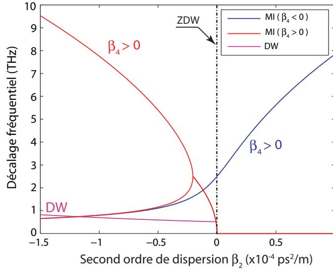
FIGURE 2.5 – Accord de phase de l'instabilité modulationnelle en fonction de l'écart en longueur d'onde entre la pompe et la dispersion nulle pour  $\beta_4 > 0$  (trait plein) et  $\beta_4 < 0$  (trait pointillé). Ces courbes représentent les solutions de l'équation (2.3).
