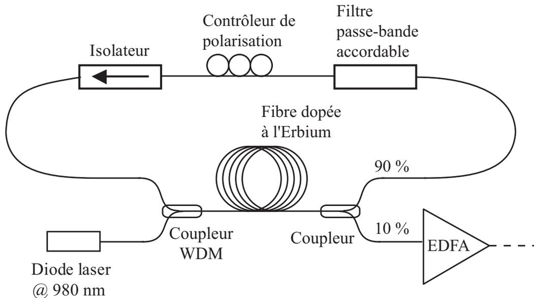
FIGURE 2.11 – Schéma du laser fibré dopé à l'Erbium.
