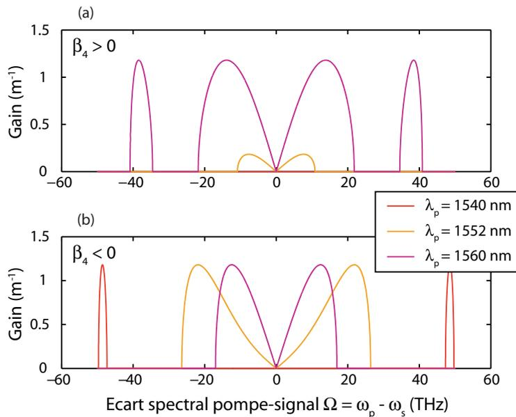
FIGURE 2.4 – Gain paramétrique associé au phénomène d’instabilité modulationnelle, représenté pour (a)  $\beta_4 > 0$  et (b)  $\beta_4 < 0$ . Ces courbes sont tracées pour différentes longueurs d’onde pompe.
