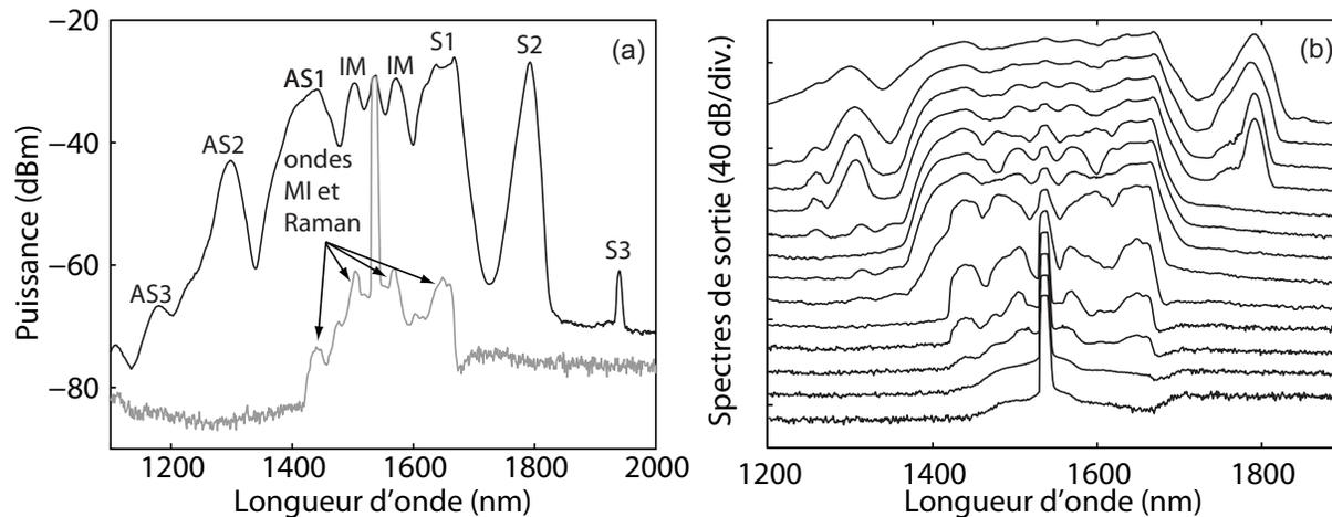
FIGURE 4.2 – (a) Spectres enregistrés à la sortie de la fibre PCF pour deux puissances de sortie égales à  $200 \mu\text{W}$  (courbe grise) et  $1 \text{ mW}$  (courbe noire). Les lettres S et AS désignent les ordres Raman Stokes et anti-Stokes et IM désigne les bandes d'instabilité modulationnelle. (b) Spectres enregistrés à la sortie de la fibre PCF pour une puissance d'entrée croissante. La puissance de sortie s'étale de  $50 \mu\text{W}$  à  $1,3 \text{ mW}$ .
