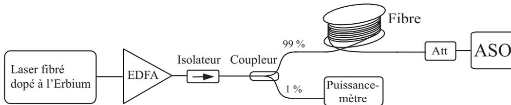
FIGURE 2.10 – Schéma du montage expérimental. EDFA (*Erbium Doped Fiber Amplifier*) signifie amplificateur fibré dopé à l'Erbium et ASO est un analyseur de spectre optique.
