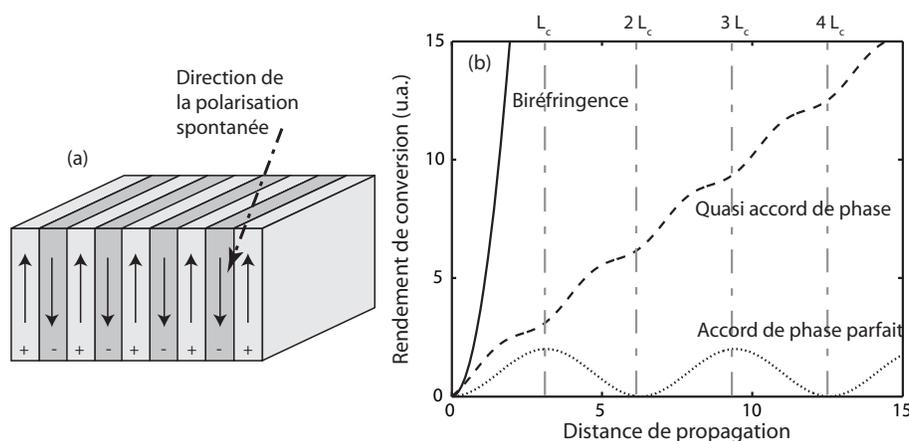
FIGURE 4.5 – (a) Structure d'un réseau à polarisation périodiquement inversé dans un cristal non linéaire  $\chi^{(2)}$ . (b) Comparaison du rendement de doublage de fréquence, entre l'accord de phase par biréfringence (trait plein), l'accord de phase dans le Niobate de Lithium (tirets) et le quasi-accord de phase (pointillés).
