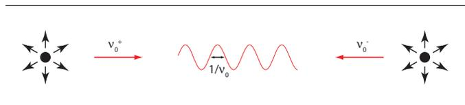
FIGURE 3.3 – Schéma de principe de la diffusion Rayleigh dans les fibres optiques.
