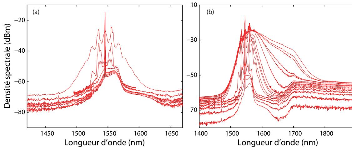
FIGURE 3.12 – Spectres enregistrés à la sortie d’une fibre monomode standard dans laquelle le laser a été injecté. La puissance en sortie de la fibre varie de (a) 8 mW à 110 mW et de (b) 3 mW à 230 mW.
