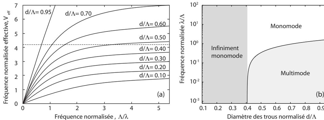
FIGURE 1.8 – (a) Fréquence normalisée  $V_{\text{eff}}$  d'une PCF à cœur plein en fonction du rapport  $\Lambda/\lambda$ , où  $\Lambda$  représente la période de la microstructure et  $\lambda$ , la longueur d'onde.  $d$  est le diamètre des trous. La droite en pointillés représente la limite au-delà de laquelle la fibre est multimode. Source : [5]. (b) Représentation des régimes monomodes et multimodes d'une PCF à partir de l'équation (1.3) établie par Folkenberg [20].
