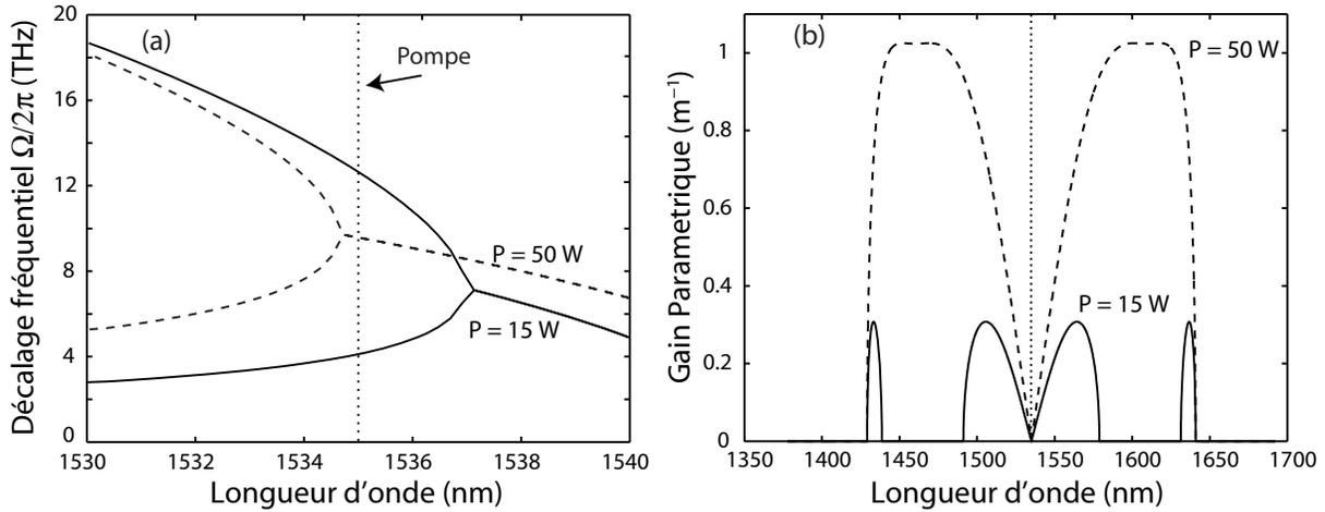
FIGURE 4.3 – (a) Décalage fréquentiel entre la pompe et les bandes d'instabilité modulationnelle ( $\Omega/2\pi$ ) en fonction de la longueur d'onde de pompe pour une puissance crête faible égale à 10 W (trait plein) et pour une puissance crête plus élevée égale à 50 W (pointillés). (b) Spectres de gain paramétrique correspondant aux courbes de la figure (a).
