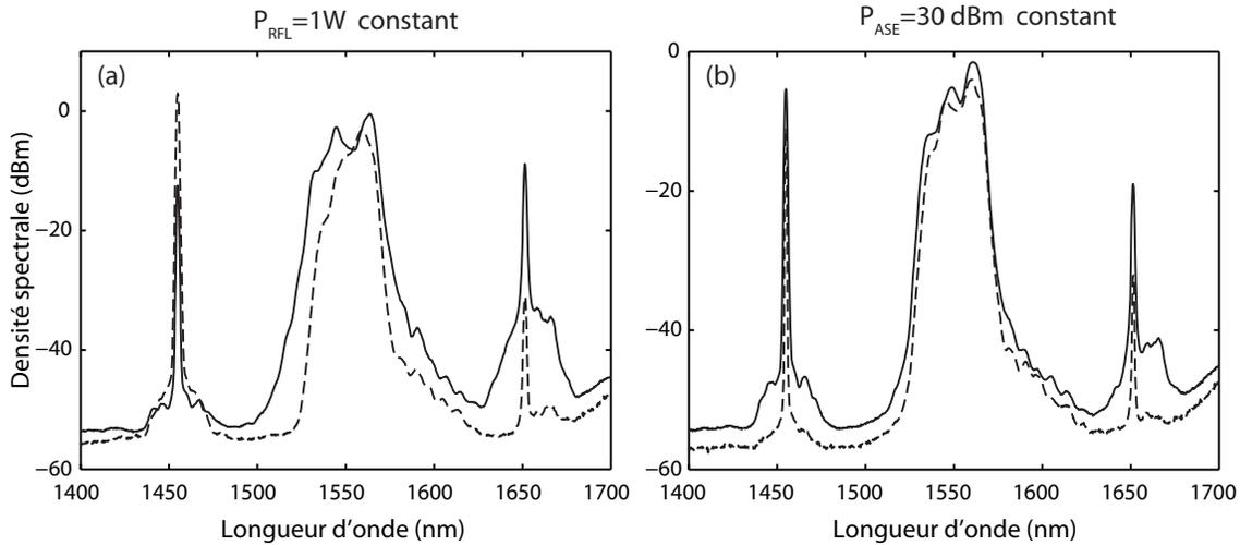
FIGURE 2.21 – Spectres de mélange à quatre ondes entre le laser Raman et la source de bruit ASE (a) pour  $P_{ASE}$  égale à 30 dBm et  $P_{Raman}$  égale à 100 et 900 mW et (b) pour  $P_{Raman}$  fixée à 1W et  $P_{ASE}$  égale à 25 et 33 dBm.  $P_{ASE}$  est la puissance de la source ASE et  $P_{Raman}$  est la puissance du laser Raman.
