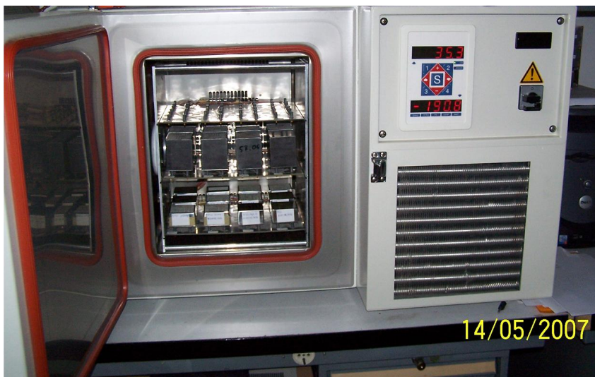
FIGURE 5.8: Etuve thermique contenant les baies qui reçoivent les oscillateurs mannequins.
