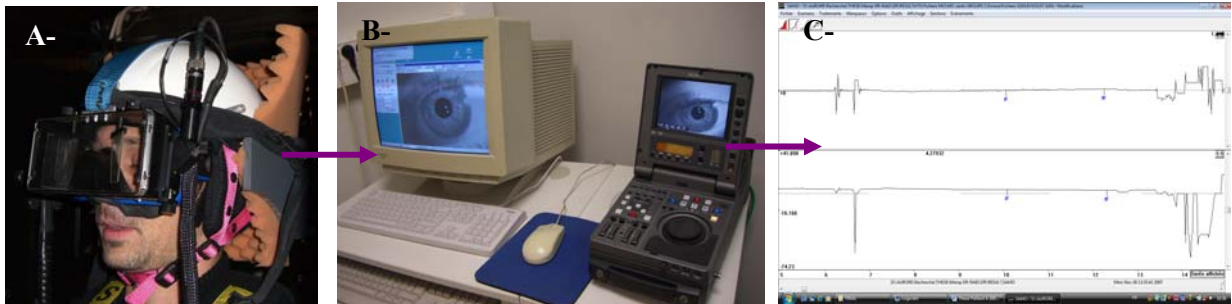
Figure 42. Montage expérimental pour l'analyse des mouvements oculaires : A- Photo du casque permettant l'enregistrement des mouvements oculaires, B- Le PC et le magnétoscope permettant l'enregistrement et l'extraction des données, C- Exemple de tracé de mouvements oculaires (i.e. direction de regard en centrifugeuse, durée de 10 secondes) analysé avec le logiciel SAMO.
