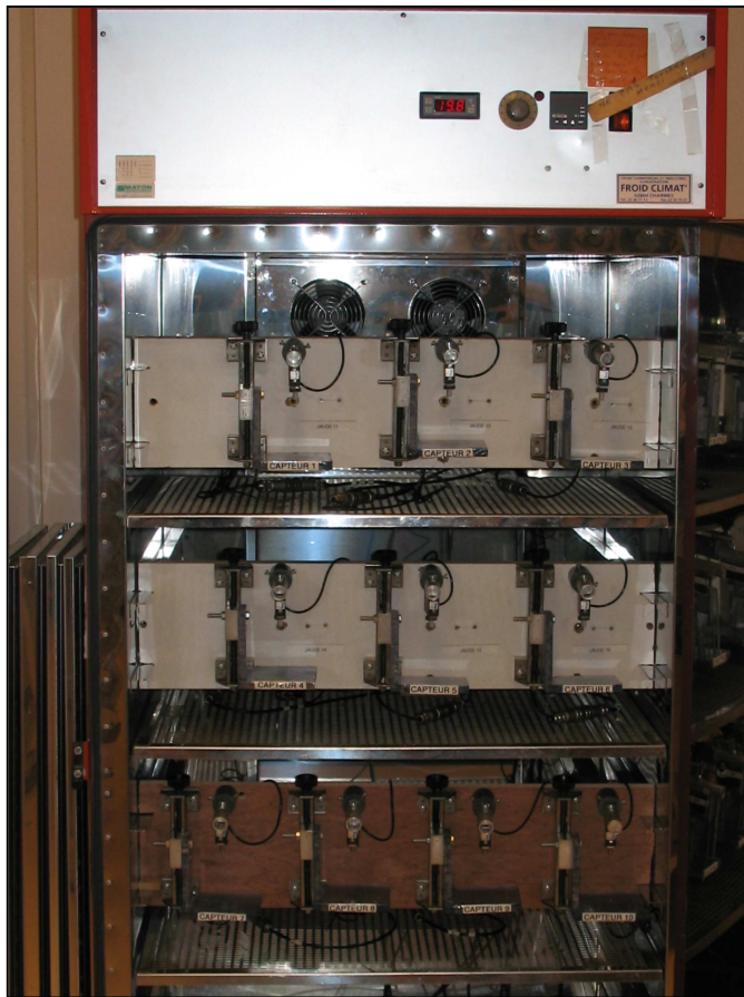
Figure 1.9 : Dispositif de mesure des forces d'émergence : enceinte renfermant les capteurs et détails de la mise en place d'une plantule (axe de l'hypocotyle) sous la jauge.
