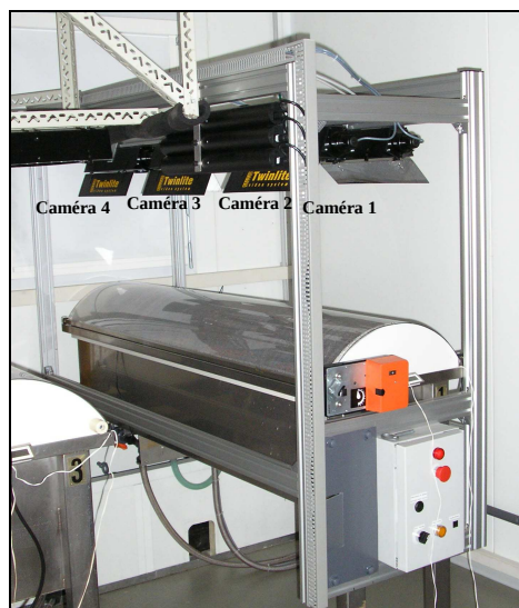
Banc de germination avec les 4 caméras
