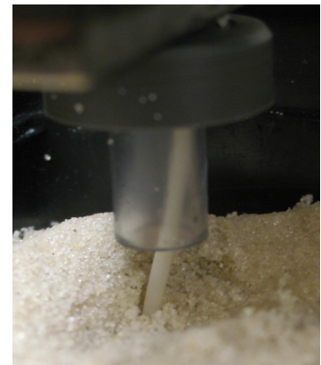
Figure 1.9 : Dispositif de mesure des forces d'émergence : enceinte renfermant les capteurs et détails de la mise en place d'une plantule (axe de l'hypocotyle) sous la jauge.
