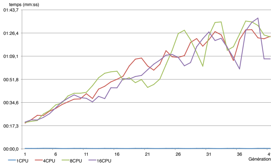
FIGURE 4.7 – Temps de calcul nécessaire pour calculer 100 générations du problème One-Max en utilisant 1, 4, 8 et 16 processeurs. Du fait du court temps de calcul nécessaire pour calculer la fonction d'évaluation, le réseau ralentit le calcul général.
