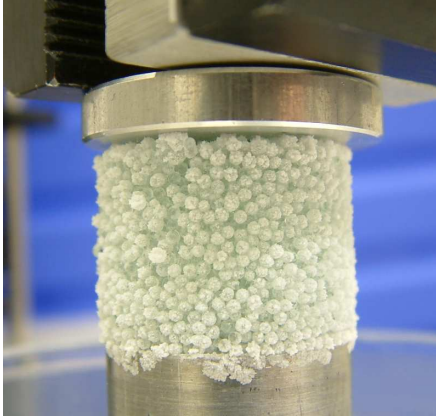
FIG. 5.15 – Échantillon de billes de verre cimenté par du sel cristallisé.
