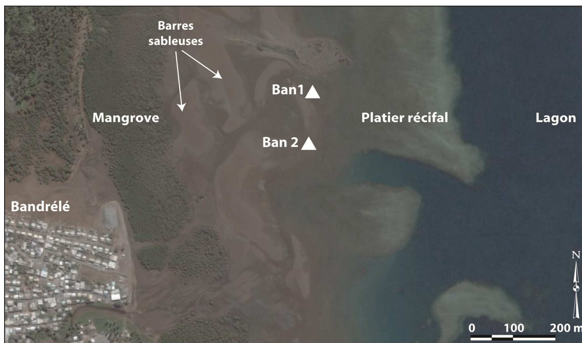
Figure 5.27: Déploiement des courantomètres houlographes sur le site de Bandrélé. Cette image satellitale GoogleEarth© (Date de l'image : 08/06/2005 ; 12°54'54.68''S – 45°04'42.80''E) montre les différentes unités morphologiques et la complexité du récif frangeant ainsi que la localisation des instruments de mesures mentionnés dans le tableau 5.8 .
