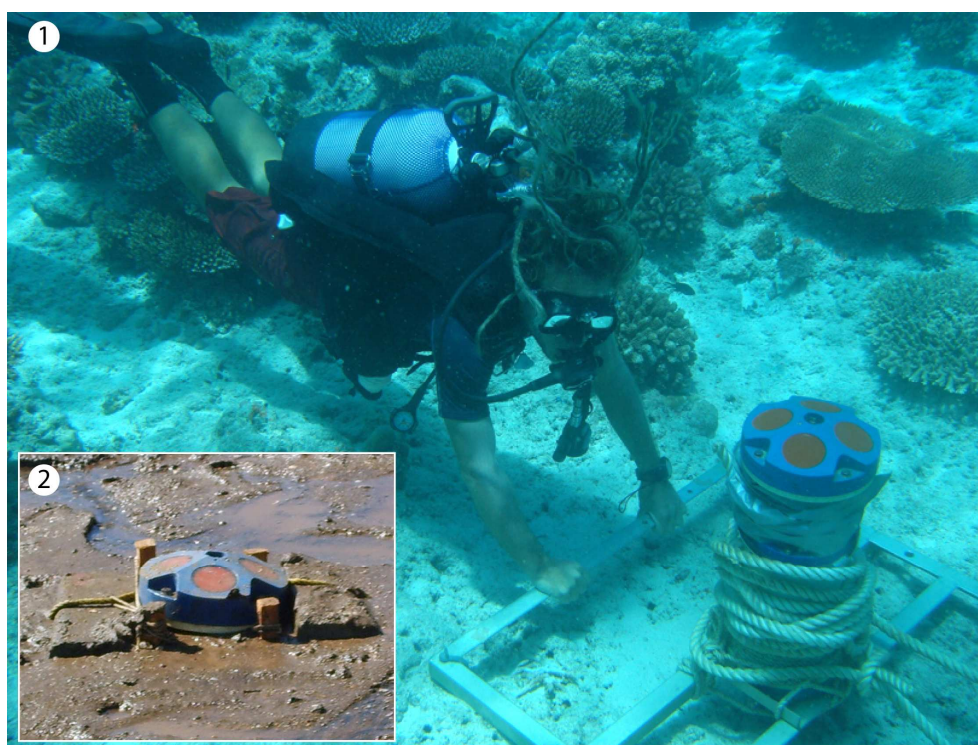
Figure 3.2 : Photographies d'ADCP déployés sur le récif barrière sud de Mayotte (1) et sur la plage de Trévani (2) ; clichés M. Jeanson.
