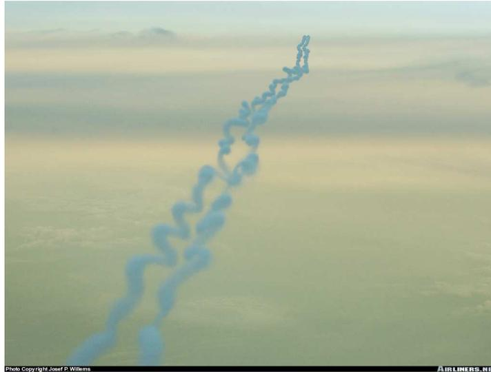
FIG. 1.2 – Sillage d’un avion dans le champ moyen, illustré par l’éjection de fumées lors de tests grandeur nature (@airliners.net).
