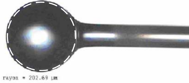
Figure I-4 : Photo d'une microsphère de 202.7 \mu\text{m} de rayon réalisée par fusion au moyen d'un arc électrique l'ENSSAT-FOTON. Le cercle clair en pointillé montre le faible taux d'ellipticité obtenue par fusion par arc électrique
