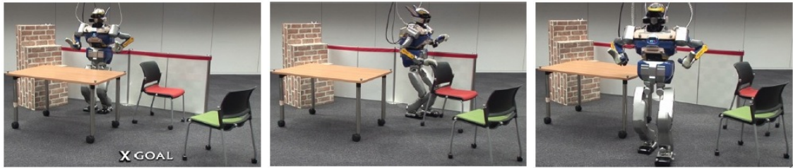
FIGURE 2.30 – de [Stilman et al. 2006a] Séquences d'une planification de manipulation exécutée par HRP-2 (temps = 0s, 36s et 59s). Le robot sélectionne la chaise pour libérer le chemin et atteindre son but
