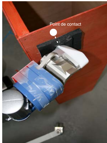
FIGURE 4.20 – Le point de contact avec l'objet est légèrement décalé à l'intérieur de celui-ci pour exercer une pression suffisante au maintien de la boîte. Nous rajoutons aussi de la bande adhésive antidérapante.
