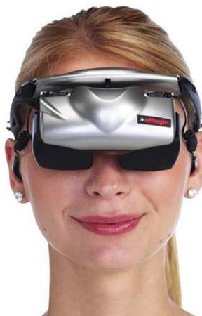
Fig. 5.3 - Image d'un oculomètre couplé à un HMD pour l'analyse des stratégies visuelles en EV.
