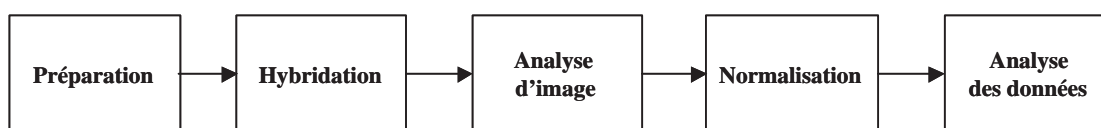
Figure 1.1 – Étapes d'une analyse par puces à ADN.
