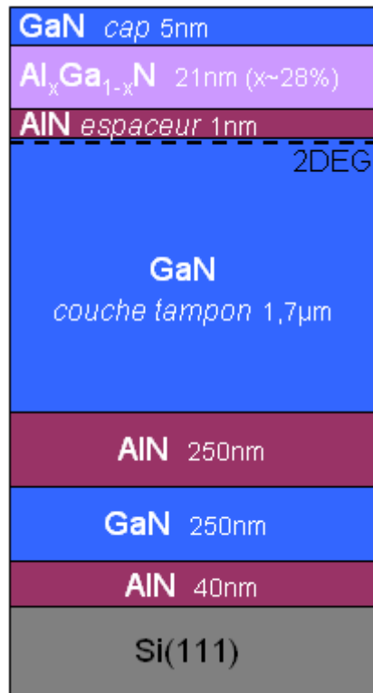
Figure II-12 : schéma d'une structure HEMT (Al,Ga)N/GaN « standard » épitaxiée sur substrat Si(111)
