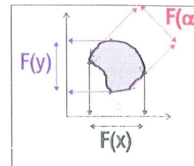
Fig. II-8: Exemple de diamètres de Férét pour les directions x, y et  $\alpha$  dans le cas d'un seul marqueur.
