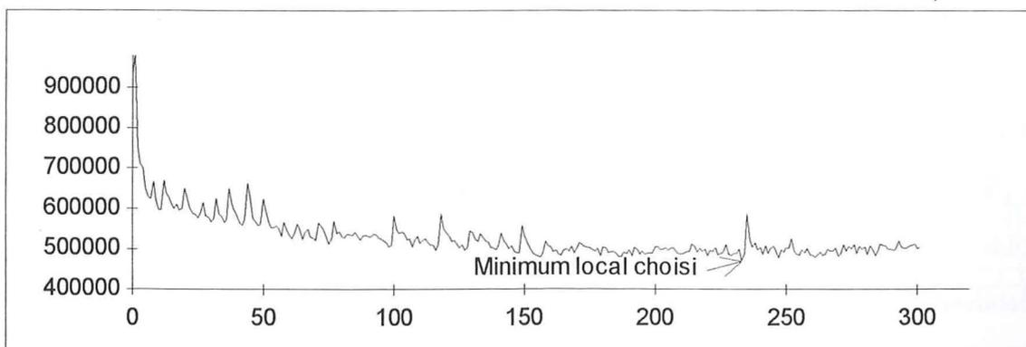
Fig. IV-10: Courbe de la fonctionnelle. Cette courbe représente l'évolution de la somme des distances au carrés pour chacun des couples segment unitaire - segment voisin en fonction du numéro de l'itération correspondante. Le minimum local de cette courbe reflète le nombre d'itérations nécessaires pour obtenir un ajustement le meilleur possible.
