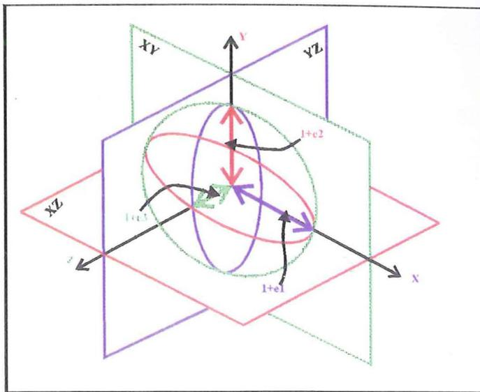
Fig. III-1: Ellipsoïde de la déformation. Définition des directions principales X, Y et Z, des extensions principales  $e_1$ ,  $e_2$  et  $e_3$  et des plans principaux de la déformation XZ, YZ et XY (d'après Ramsay & Huber, 1983).
