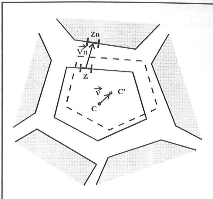
Fig. IV-9: Déplacement d'un bloc de barycentre C vers une position C' par translation. La somme des vecteurs élémentaires  $V_n$  est égale au vecteur de translation V.
