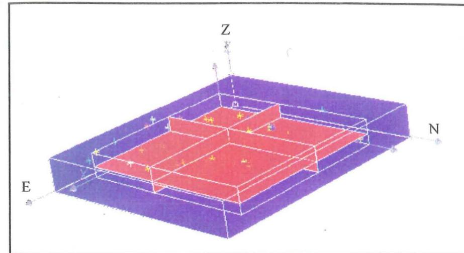
Fig. III-13: Voxet d'interpolation (en bleu) et voxet extraite (en rouge). La voxet d'interpolation (resp. extraite) est constituée de parallélépipèdes carrés de 500m de côté et de 100m d'épaisseur. Elle montre 28 éléments (resp. 20) selon la direction E-W, 26 (resp. 18) en N-S et 18 (resp. 13) selon la verticale.
