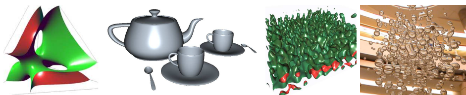
FIGURE 3.2 – Différents types de surfaces algébriques rendues par raycasting sur GPU : (a) surfaces de Bézier de degré 4 [LB06], (b) NURBS [PSS + 06], (c) surfaces implicites [KHK + 08] et (d) metaballs [KSN08].
