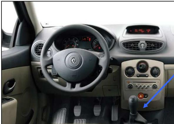
**L'emplacement spécifique pour connecter la clé USB sera situé en bas de la console de pilotage.**
