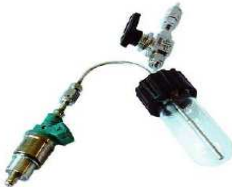
FIG. 2.3 – Système d'injection avec l'injecteur (au premier plan) et le réservoir. La solution de précurseur est pressurisée sous gaz neutre.
