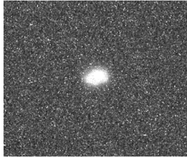
Figure III-8: Emission de radioluminescence d'un substrat de GaN dopé silicium et irradié par un faisceau de photons de 6MV
