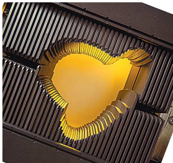
Figure I-4: Les collimateurs multi-lames (Source iconographique : Varian Medical System)
