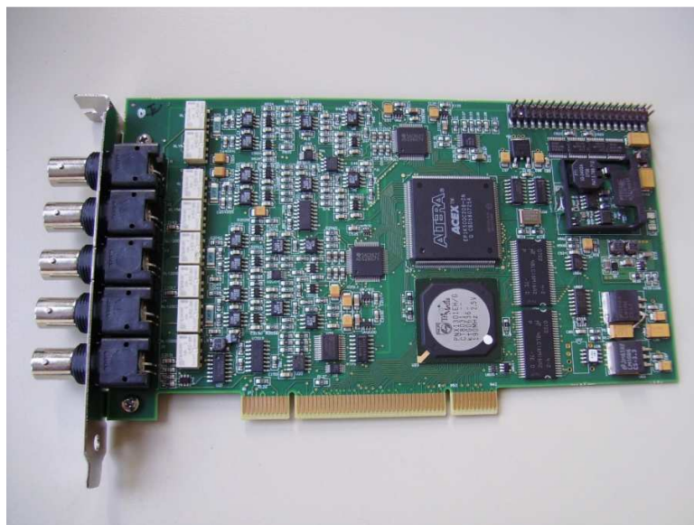
Figure II-25: La carte d'acquisition Acquitek
