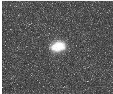
**Figure III-8: Emission de radioluminescence d'un substrat de GaN dopé silicium et irradié par un faisceau de photons de 6MV**
