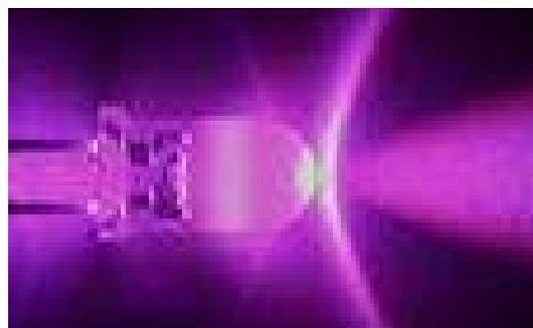
**Figure I-19: électroluminescence du nitrure de gallium**
