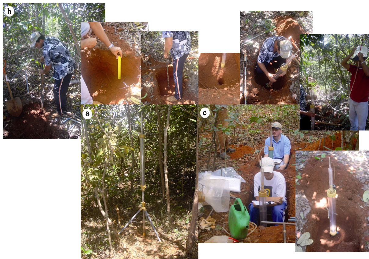
Figure III.2 - Détermination de la conductivité hydraulique saturée ( K_s ) sur terrain : a) Perméamètre de Guelph en détail sur trépied, b et c) séquence de l'installation, et la procédure de mesure du niveau d'eau.
