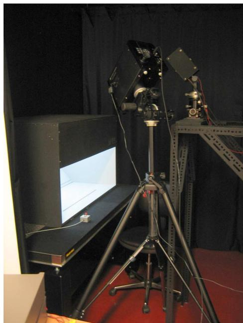
Fig. 4.6. - Configuration du banc de caractérisation des éclairages à LED de la cabine à lumière dans le cadre des mesures visuelles.
