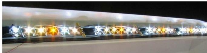
Fig. 3.4. - LED montées sur un dissipateur thermique et mises en place à l'intérieur de la cabine.
