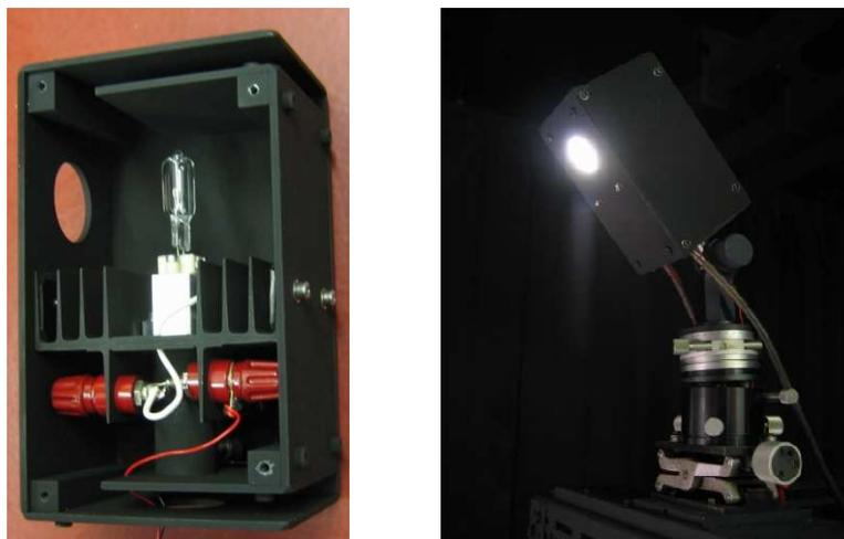
Fig. 3.10. - A gauche : vue de l'intérieur de la lanterne contenant la lampe tungstène halogène de référence. A droite : lampe en fonctionnement sur son support.
