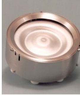
Figure III-32 : Photographie montrant l'érosion d'une cible de zirconium après utilisation lors de la pulvérisation cathodique magnétron.
