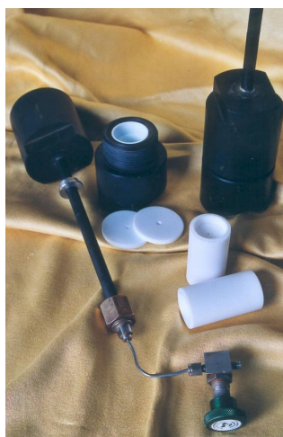
Figure I-13 : Photographie du Réacteur Autoclave Micro-Onde (RAMO).
