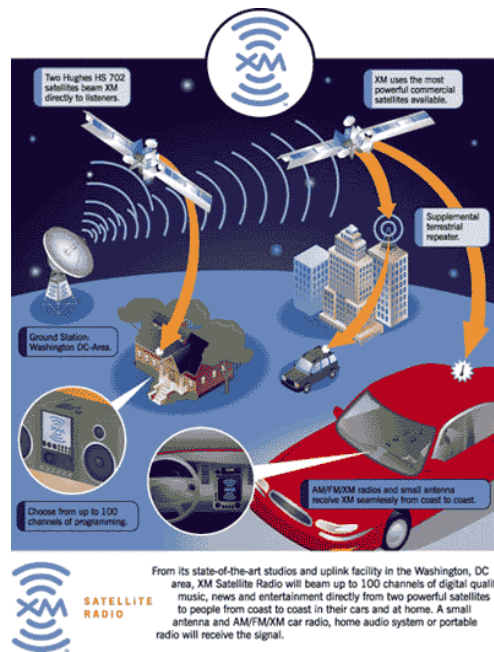
Figure 1.27: Principe de fonctionnement de XM radio
