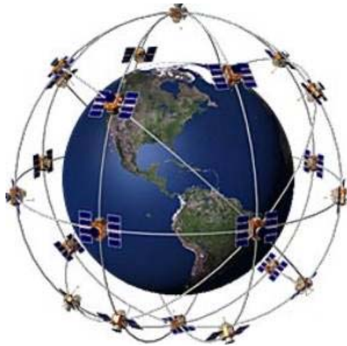
Figure 1.17: Répartition des satellites du système GPS
