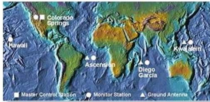
Figure 1.18: Position des stations de contrôle terrestres
