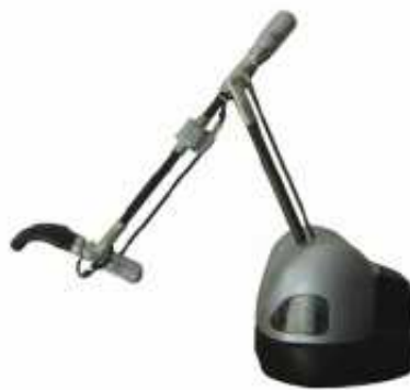
FIGURE 10.1 – Bras à retour d'effort Haption TM utilisé au cours de l'expérimentation. Ce périphérique est capable de produire des efforts linéaires d'un niveau de 10N en continu avec des pointes pouvant atteindre 35N .
