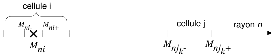
FIG. IV.2: Chemin optique d'un rayon n émis de la cellule i au point M_{ni} .
