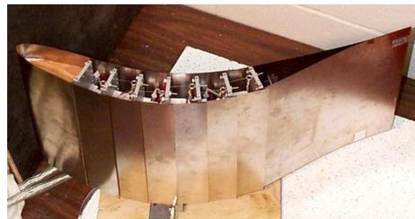
Figure 1.28 – Aileron déformable utilisant des fils en Alliage à Mémoire de Forme par Rediniotis *et al.* (2002).
