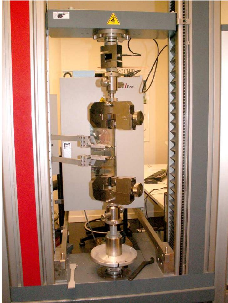
Figure 2.3 – Montage utilisé lors des essais de traction.
