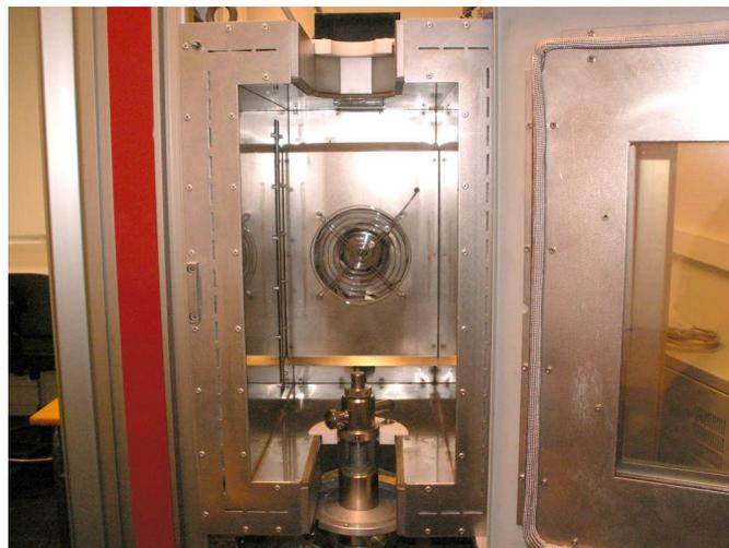
Figure 3.2 – Enceinte thermique utilisée pour les essais à température contrôlée.
