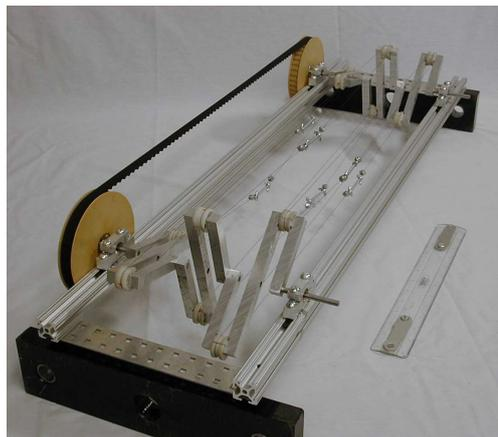
Figure 1.31 – Moteur rotatif à base de fils en Alliage à Mémoire de Forme par Schiller (2002).
