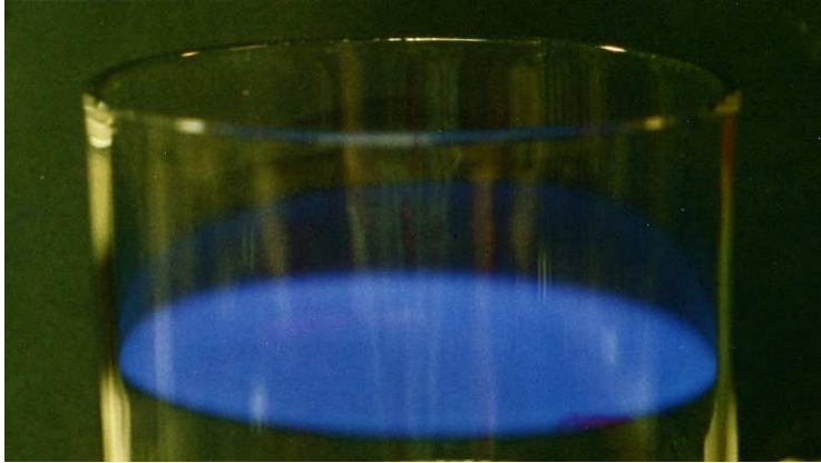
FIG. B.4 – Photo d'une flamme plane, stabilisée paramétriquement.
