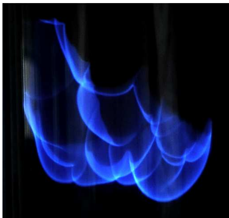
FIG. B.3 – Photo d'une flamme soumise à l'instabilité de Darrieus-Landau.
