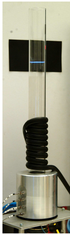
FIG. 2.5 – Le petit brûleur et les capteurs de pression acoustique. Une flamme plane est visible dans la partie supérieure du tube.
