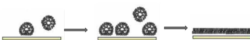
Schéma 14 : Principe de formation d'une bicouche par fusion et étalement de vésicules sur une surface de silice ou de mica. Lorsque que la concentration critique en vésicules est atteinte sur la surface, elles fusionnent entre elles et s'étalent pour former la bicouche.
