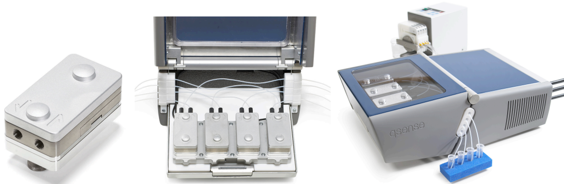
Schéma 44 : A gauche, un module utilisé pour le mode flux continu ; Au milieu, les quatre modules installés en parallèle dans le modèle E-4 ; A droite, le modèle de QCM-D en fonctionnement, avec les solutions à injecter d'un côté et la pompe péristaltique de l'autre.
