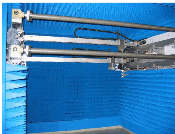
FIG. 5.12 – Photo de la petite chambre anéchoïque, où l'on voit les positionneurs mécaniques dédiés aux antennes d'émission et de réception.
