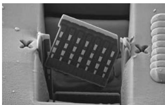
FIG. 2.3 – Lift-off d'une préparation TEM
