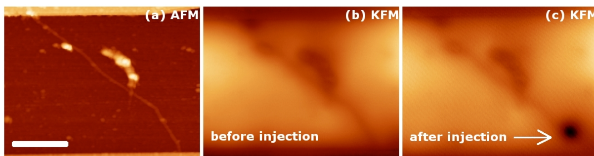
FIG. 3.13 – Injection de charges locales à proximité d'un CNTFET (a) Image AFM du CNTFET SC2, la barre d'échelle correspond à 1 \mu m . (b) Image de KFM avant l'injection de charges du transistor SC2. (c) Image de KFM après l'injection de charges négatives à proximité du nanotube.
