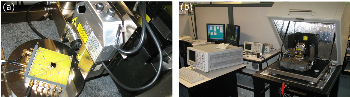
FIG. 3.1 – (a) Photographie du montage expérimental. Le circuit imprimé, avec au centre l'échantillon sur lequel est fabriqué le transistor à nanotube, est déposé sous la tête de mesure du microscope à force atomique Dimension 3100™. Les pistes du circuit sont reliées électriquement aux reports de contacts de source, drain et grille, qui sont elle-mêmes reliées à un analyseur de semiconducteur HP 4155™. (b) L'analyseur de semiconducteur (à gauche sur la photographie) est placé à proximité du microscope (à droite), le microscope est isolé par un coffre antivibration.
