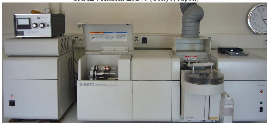
Figure 50 : Appareils de spectrométrie d'absorption atomique en flamme ou électrothermique.
