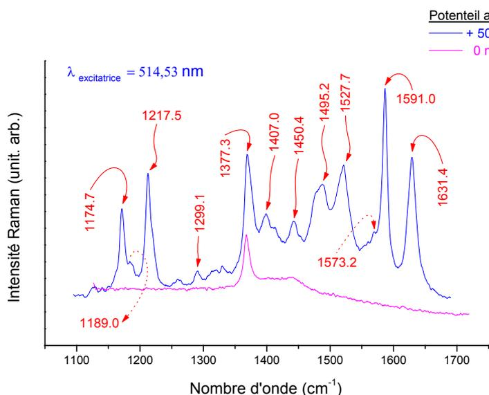
Figure II.35 : Spectres de diffusion Raman des formes monoprotonées  $B3^+$  à 514.53 nm à hautes fréquences.
