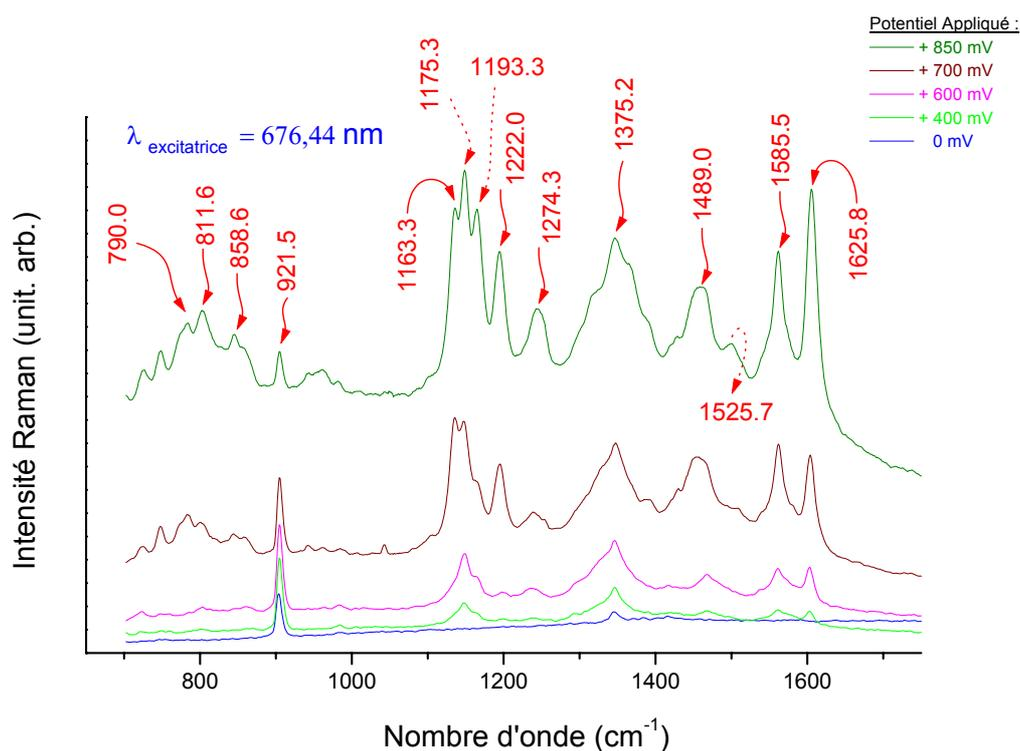
Figure II.36 : spectres de diffusion Raman « in-situ » de B5 ( $10^{-3}$  M) dans le benzonitrile + Tetrabutyl ( $10^{-1}$  M) + DPPH ( $5 \cdot 10^{-2}$  M) à 676,44 nm, à différents potentiels imposés.
