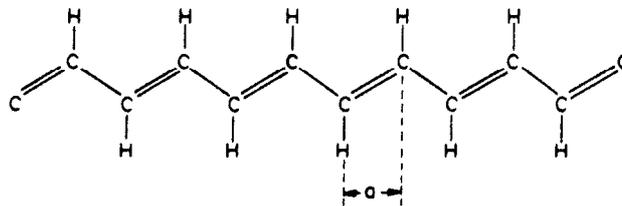
Figure I.4 : Configuration du trans- $(CH)_x$ .
