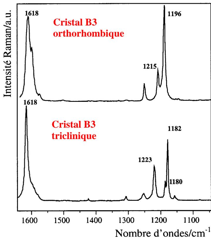
Figure III.6 : spectres Raman des cristaux de B3
