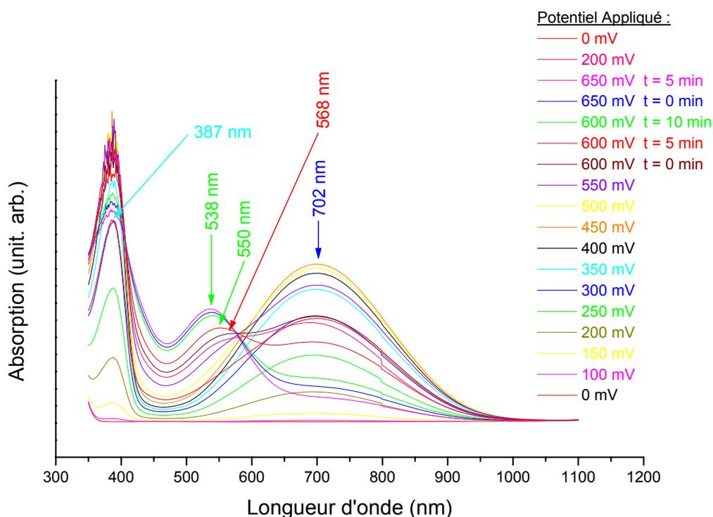
Figure II.14 : Spectres d'absorption optique « in-situ » du B3 dans ACN/NaClO<sub>4</sub> sans acide à différents potentiels imposés (et en fonction du temps d'exposition).
