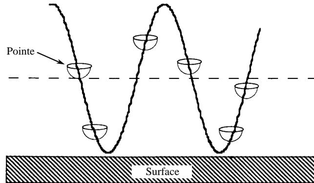
Figure IV.5 : Représentation de l'oscillation sinusoïdale de la pointe au voisinage d'une surface.
