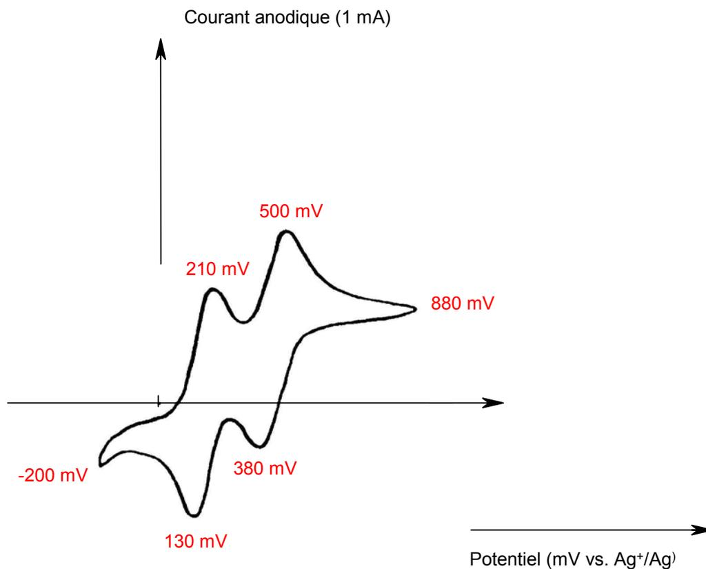
Figure II.4 : Cyclovoltammogramme du B3 ( $10^{-3}$  M) dans acétonitrile/TEABF<sub>4</sub> ( $10^{-1}$  M) et du diphenyle phosphate ( $5 \cdot 10^{-2}$  M) pour une vitesse de balayage de 50 mV/sec (- 300 à 900 mV vs. Ag<sup>+</sup>/Ag).
