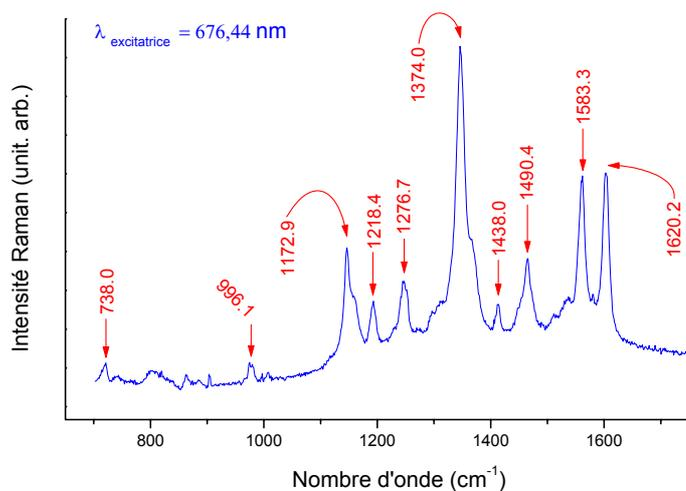
Figure IV.38 spectre de diffusion Raman d'une couche mince de B3 à 676,44 nm dopée par HCl 1M.
