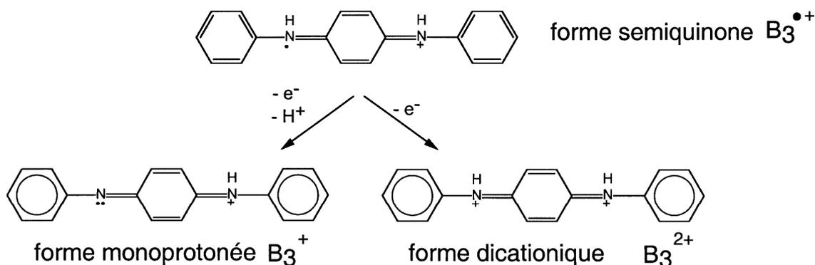
Figure II.6 : Représentation schématique des processus électrochimiques pouvant intervenir lors de la seconde vague d'oxydation.
