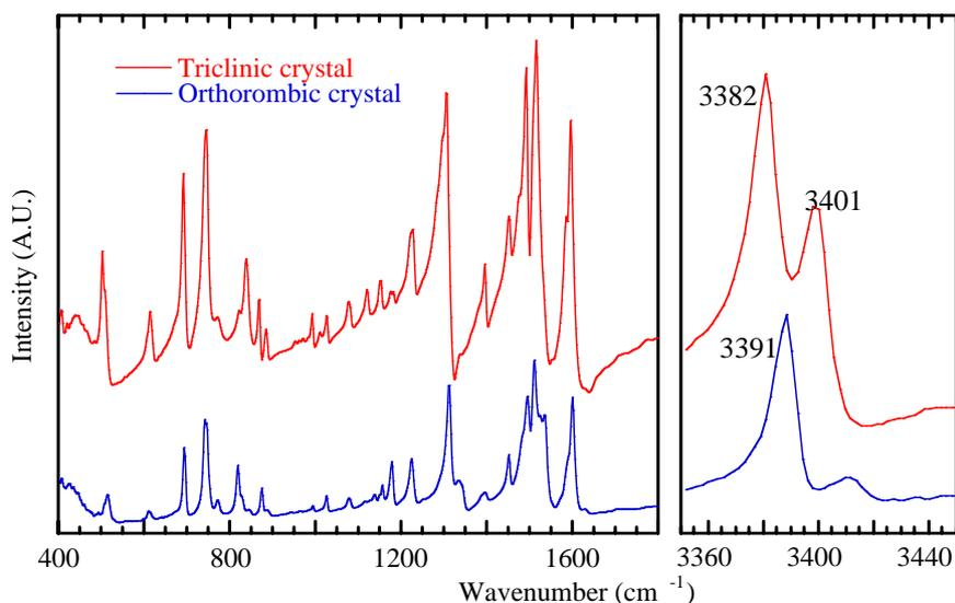
figure 5 : spectres d'absorption infrarouge des cristaux de B3
