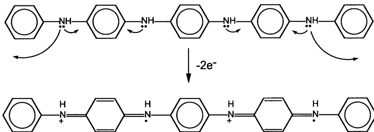
Figure II.20 : Représentation schématique de la conversion du B5 en diradical dication  $B5^{2(\bullet+)}$
