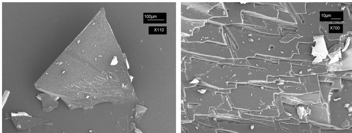
Figure IV.7 : photo (MEB) d'une lamelle de terphényliediamine
