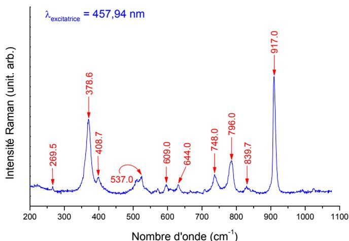
Figure II.28 : Spectres de diffusion Raman du B2Q1 à 457,94 nm à basses et hautes fréquences.
