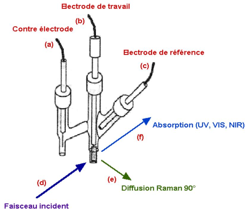
Figure II.3 Cellule utilisée lors des études in situ.
