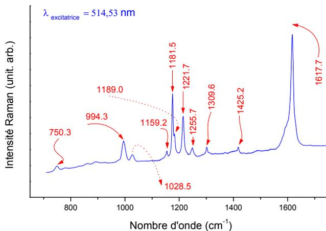
Figure IV.34 : Spectre de diffusion Raman d'une couche mince de B3 neutre à 514,53 nm : zone de couleur « **verte foncée** » de la surface de notre couche mince.
