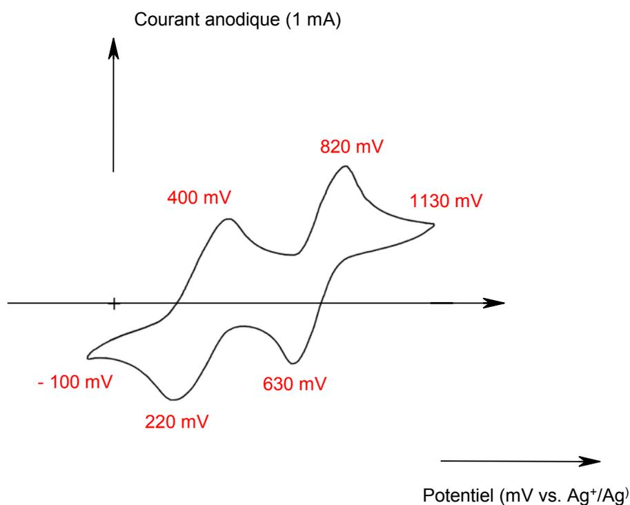
Figure II.19 : cyclovoltammogramme du B5 ( $10^{-3}$  M) dans benzonitrile/tétrafluorure de tétrabutylammonium ( $10^{-1}$  M) et du diphenyle phosphate ( $5 \cdot 10^{-2}$  M) (vitesse de balayage de 50 mV/sec et de -200 à 1200 mV vs.  $Ag^+/Ag$ ).
