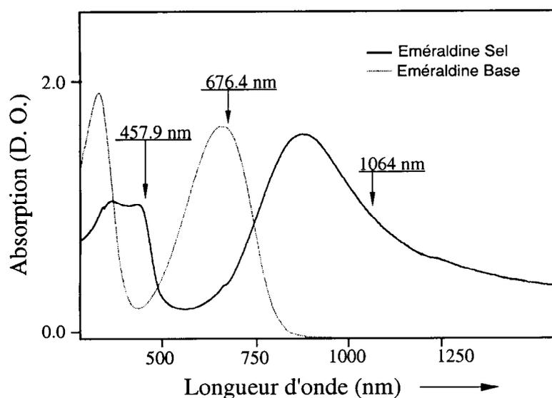
Figure 1.10 : spectres d'absorption de films d'émeraude base et d'émeraude sel
