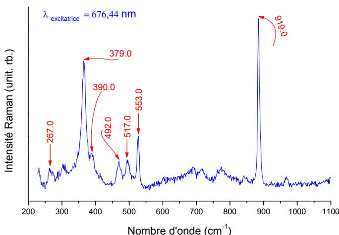
Figure II.31 : Spectres de diffusion Raman des radicaux cationiques  $B3^{\bullet+}$  issus d'une solution de B2Q1 en milieu acide à 676.44 nm.
