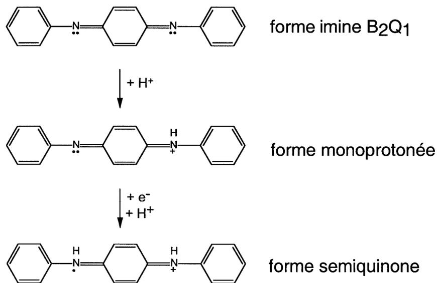
Figure II.15 : représentation schématique de la conversion du B<sub>2</sub>Q<sub>1</sub> en forme monoprotonée puis semiquinone en présence d'acide à différentes concentrations.
