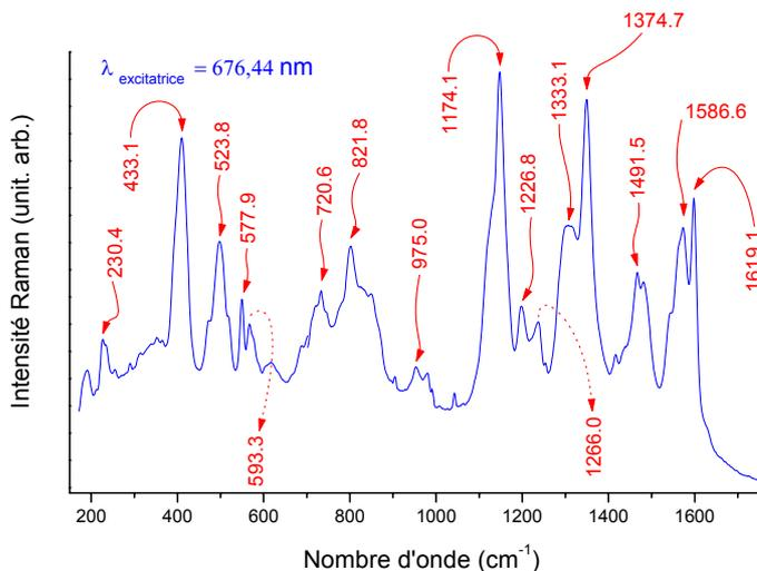
Figure IV.41 : spectre de diffusion Raman d'une couche mince de B5 (substrat verre) dopée par HCl (1M) à 676,44 nm.
