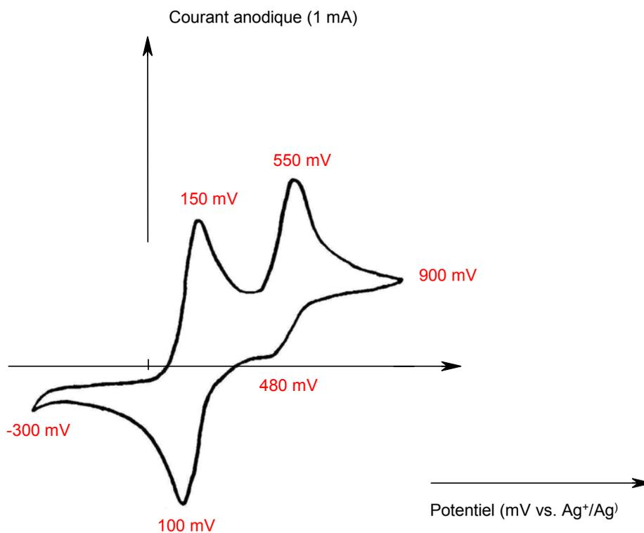
Figure II.9 : Cyclovoltammogramme du B3 ( $10^{-3} M$ ) dans acétonitrile/tétrafluoborate de tétraéthylammonium ( $10^{-1} M$ ) sans acide à la vitesse de balayage 50 mV/sec de - 300 à 900 mV vs. Ag<sup>+</sup>/Ag.
