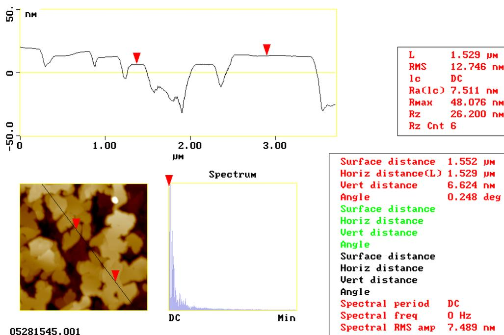
Figure IV.20 : Image AFM tapping de l'échantillon « B »
