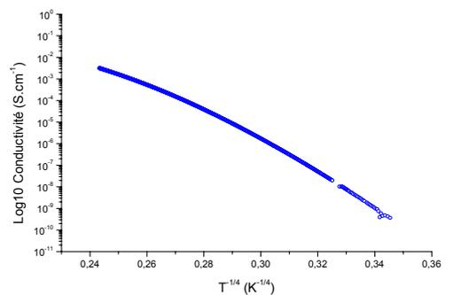
Figure.V.15 : Comportement de la conductivité  $\sigma$  de la pastille de B5 fritté chlore en fonction de la température  $T$ ,  $T^{-1}$ ,  $T^{-1/2}$  et  $T^{-1/4}$ .
