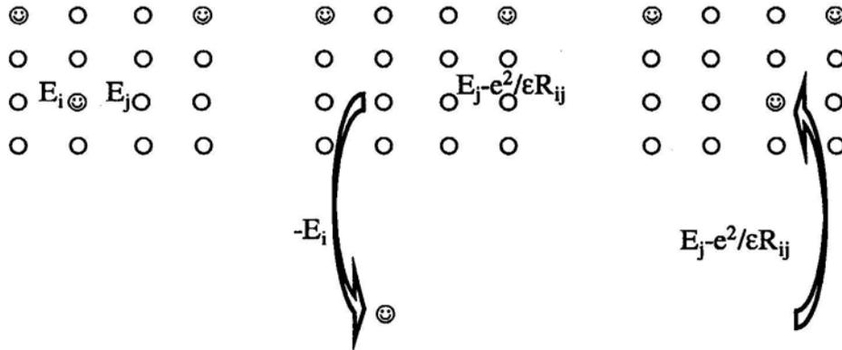
Figure.V.6 : Saut d'un porteur ☺ d'un site  $i$  à un site  $j$  en tenant compte des interactions coulombiennes.
