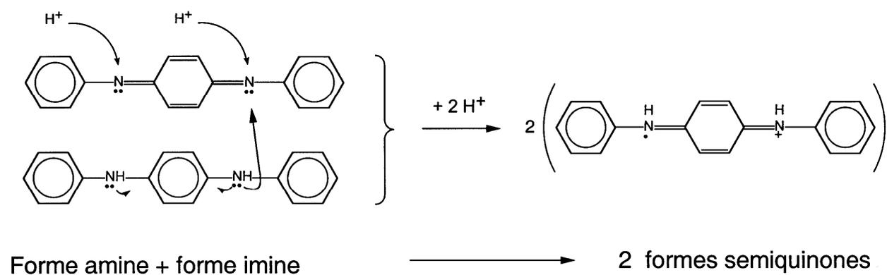
Figure II.16 : représentation schématique de la conversion du mélange stoechiométrique de B<sub>3</sub> et B<sub>2</sub>Q<sub>1</sub> en radicaux cations en présence d'acide.
