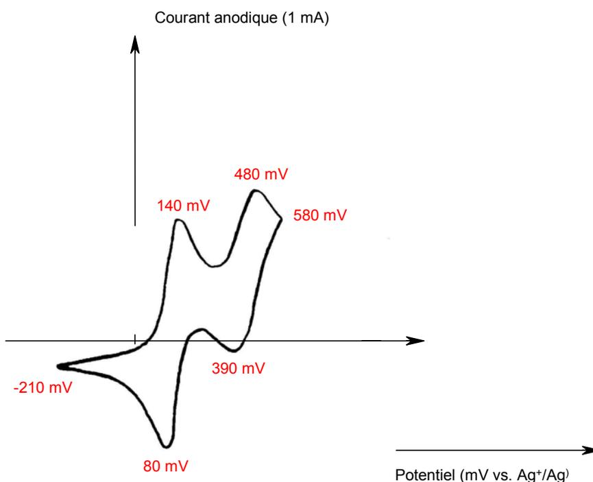
Figure II.8 : Cyclovoltammogramme du B3 ( $10^{-3}$  M) dans acétonitrile/perchlorate de sodium ( $10^{-1}$  M). Solution sans acide et vitesse de balayage de 50 mV/sec entre - 300 à 900 mV vs.  $\text{Ag}^+/\text{Ag}$ .
