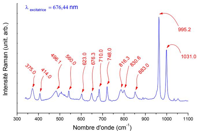
Figure IV.30 : Spectre de diffusion Raman de poudre de B3 couleur blanc gris utilisée pour les dépôts. (676,44 nm).
