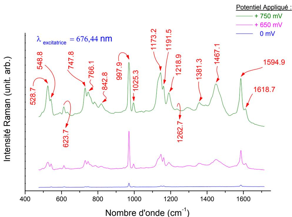
Figure II.38 : spectres de diffusion Raman « in-situ » de B5 ( $10^{-3} M$ ) dans le benzonitrile + Tetrabutyl ( $10^{-1} M$ ) à 676,44 nm, à différents potentiels imposés : 0, 400, 600, 650, 700, 750 mV vs.  $Ag^+/Ag$ .
