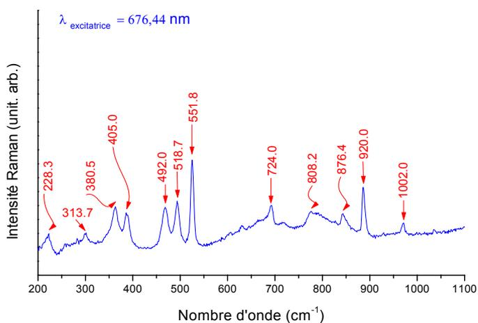
Figure II.30 : Spectres de diffusion Raman des radicaux cations  $\text{B3}^{\bullet+}$  issus du mélange de B3 et B2Q1 en milieu acide à 676.44 nm.
