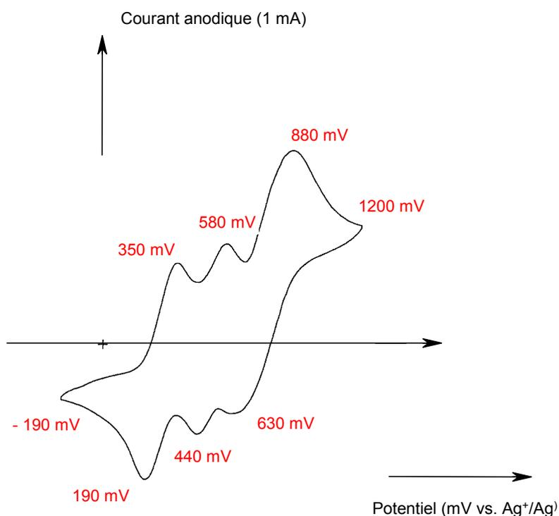
Figure II.22 : cyclovoltammogramme du B5 ( $10^{-3}$  M) dans benzonitrile/tétrafluoroborate de tétrabutylammonium ( $10^{-1}$  M) sans acide (vitesse de balayage de 50 mV/sec et de - 200 à 1200 mV vs.  $Ag^+/Ag$ ).
