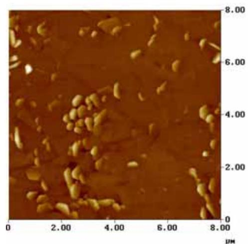
Figure IV.27 : image AFM d'une couche mince de B5
