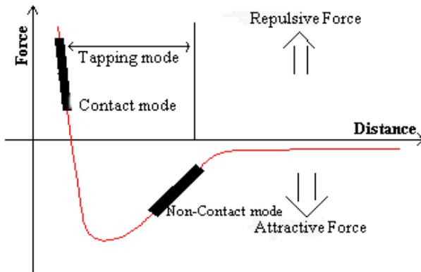
Figure IV.2 : force d'interaction pointe-échantillon en fonction de la distance les séparant.
