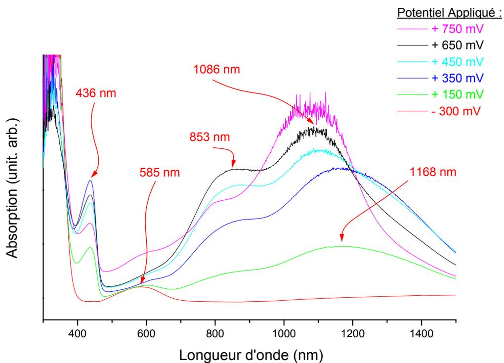
Figure II.23 : Spectre d'absorption optique de B5 dans Tetrabutyl ( $10^{-1}$  M) + Benzonitrile sans acide.
