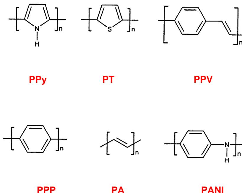
Figure I.1 : Formules chimiques de différents PCE
