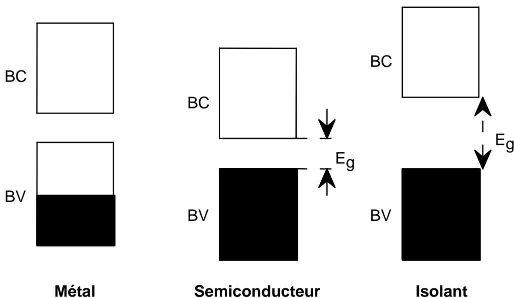
Figure I.3 : Représentation de la structure des bandes.
