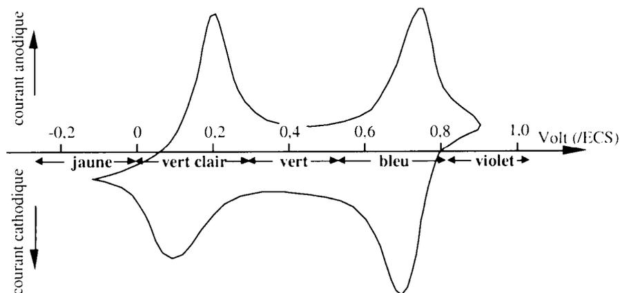
Figure I.11 : cycle voltammétrique de polyaniline
