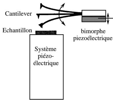
Figure IV.4 : Représentation schématique du mode contact intermittent.
