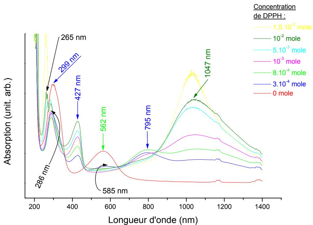
Figure II.25 : spectres d'absorption optique « in-situ » du B4Q1 en fonction des différentes concentrations  $C$  d'acide DPPH ajoutées à la solution
