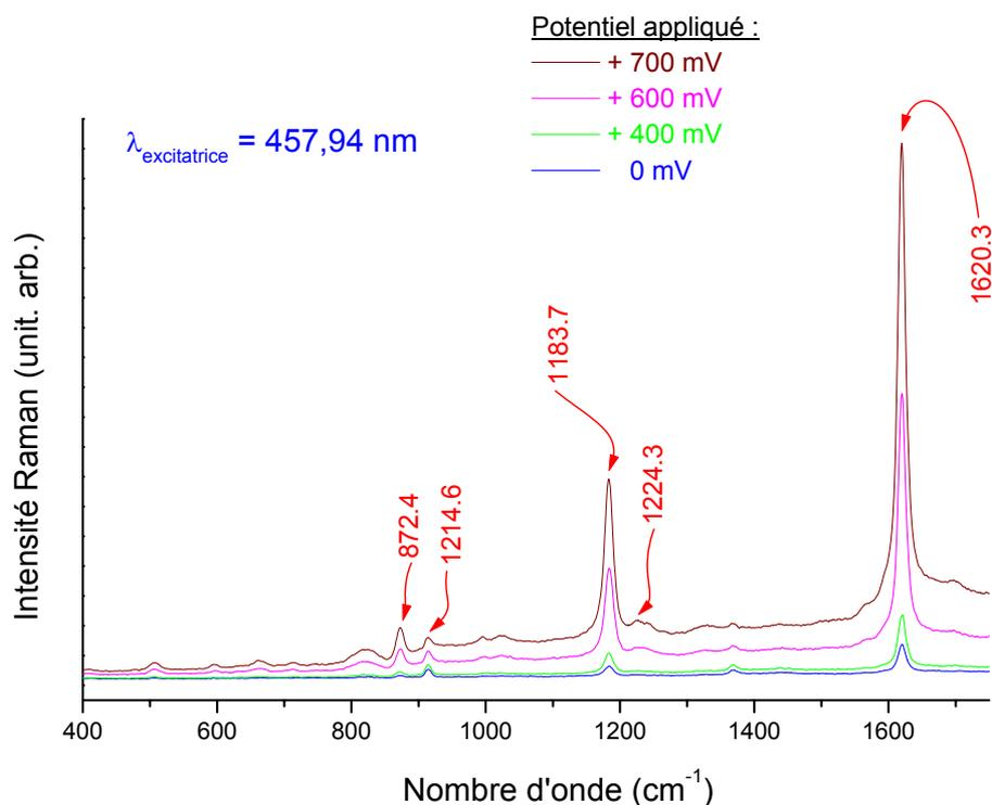
Figure II.37 : spectres de diffusion Raman « in-situ » de B5 ( $10^{-3} \text{ M}$ ) dans le benzonitrile + Tetrabutyl ( $10^{-1} \text{ M}$ ) à 457,94 nm, à différents potentiels imposés : 0, 400, 600, 650, 700, 750 mV vs.  $\text{Ag}^+/\text{Ag}$ .
