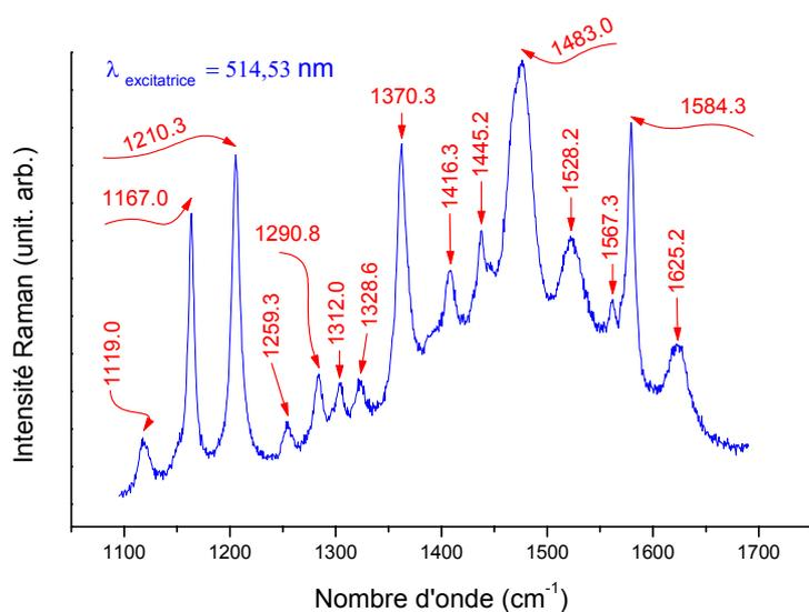
Figure II.33 : Spectres de diffusion Raman des formes monoprotonées  $B3^+$  à 514.53 nm à hautes fréquences.
