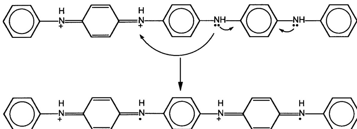
Figure II.27: Représentation schématique de la conversion de la forme dicationique  $B5^{2+}$  en diradical dication  $B5^{2(\bullet+)}$
