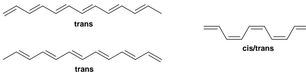
Figure I.7 : les différentes structures du polyacétylène
