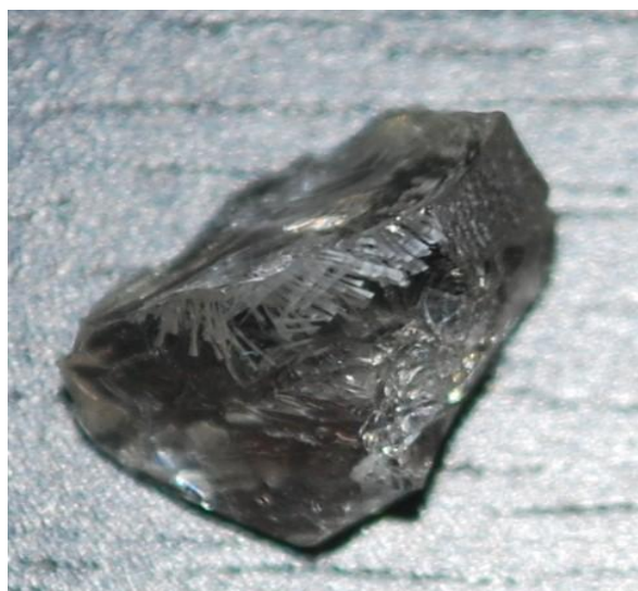
Figure IV.6. Photographie des verres II-L 0 Y 25 C 5 AS faisant apparaître des zones cristallisées
