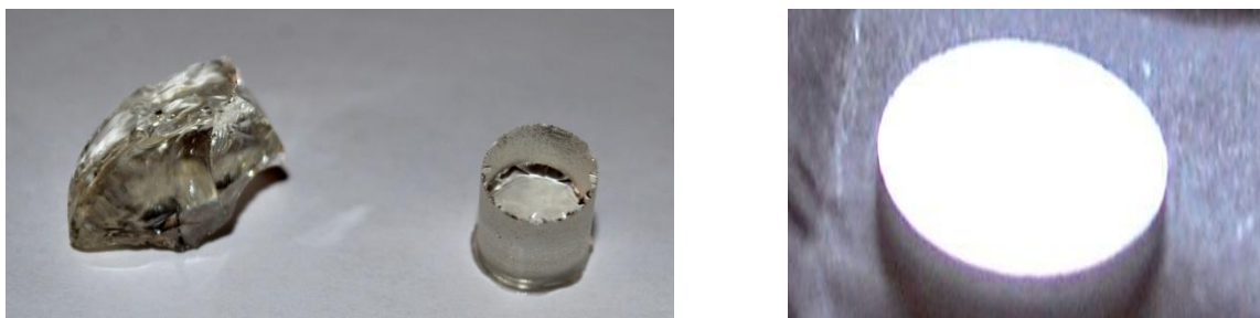
Figure IV. 5. Photographie des cylindres et des lames obtenues après carottage, découpe à la scie à fil puis polissage.
