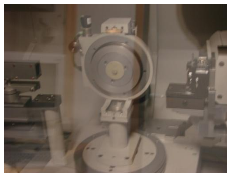
Figure IV. 22. Photographie du diffractomètre Phillips et principe du montage en incidence rasante utilisé dans cet appareillage.
