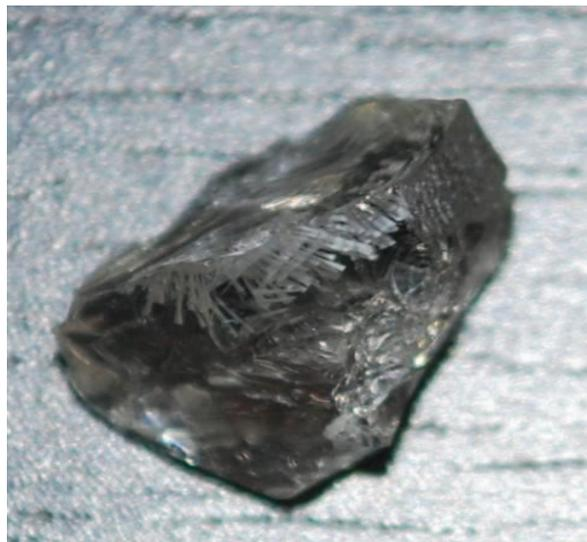
Figure IV.6. Photographie des verres II-L<sub>0</sub>Y<sub>25</sub>C<sub>5</sub>AS faisant apparaître des zones cristallisées
