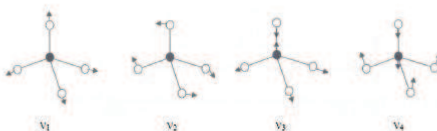
Figure IV. 31. Modes de vibration d'une entité Q_0 pour un tétraèdre de silicium isolé
