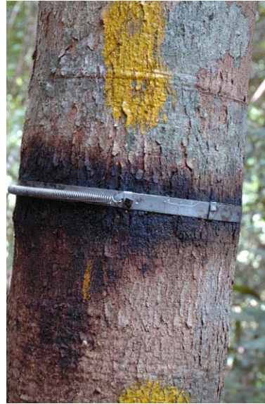
Figure 2-10. Arbre équipé d'un dendromètre à vernier.
