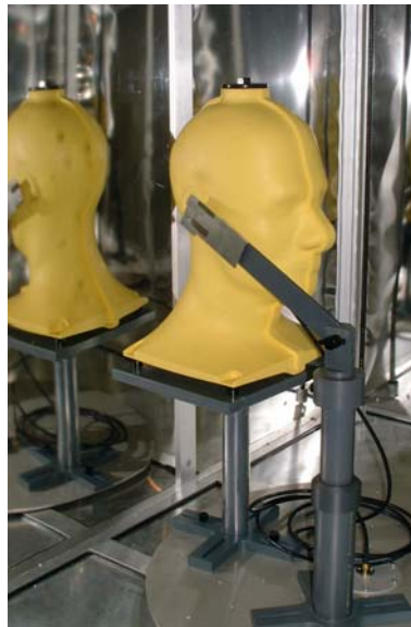
Fig. VI.9 : Photo de la mesure d'un système multi-antennes en présence de la tête de fantôme dans la chambre réverbérante
