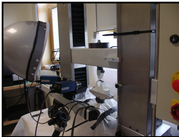
Figure 39: Montage utilisé pour la stéréocorrélation d'images
