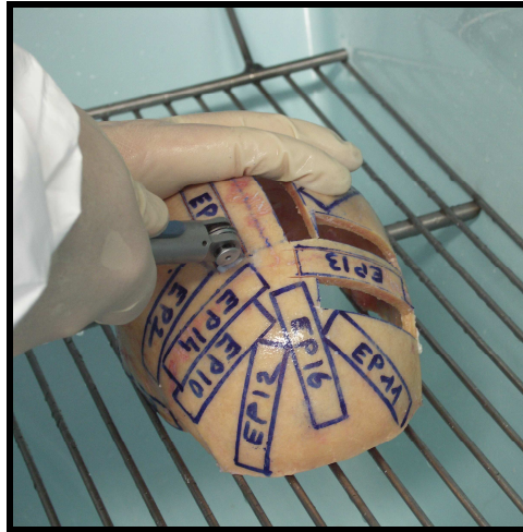
Figure 18: Découpe des éprouvettes à la scie oscillante
