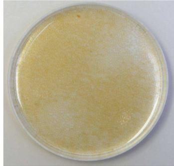
Figure 3-22 : photographie de billes d'alginate marquées à une dose de 20  $\mu$ l d'Endorem<sup>®</sup> par 1 ml de solution d'alginate.
