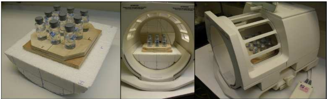
Figure 2-17 : Support tournant amagnétique composé de deux parties : une partie fixe en polystyrène pour centrer les échantillons au centre de l'antenne et du tunnel de l'IRM, l'autre tournante en bois. Les figures au milieu et à gauche illustrent les deux parties du support avec les flacons dans et hors l'antenne cage d'oiseau (Quad Head).
