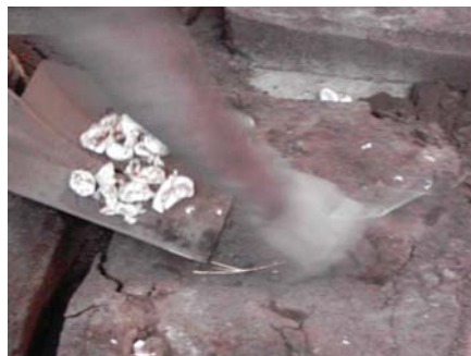
Figure 11 : Récupération des morceaux d'aluminium solidifiés hors du moule.
