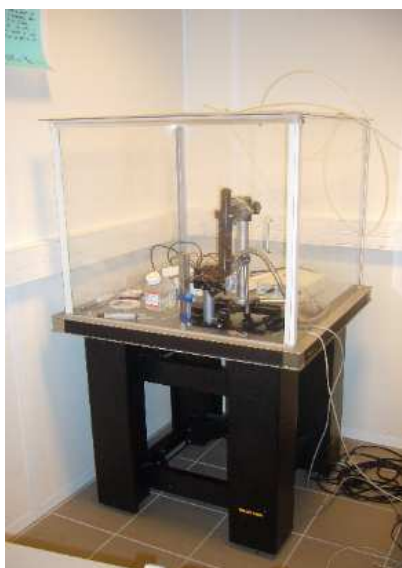
figure 4.13 : Photo de la cage en surpression destinée à limiter la poussière dans l'air.
