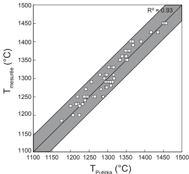
**Figure II.9** Comparaison entre les températures expérimentales et les températures calculées par le géothermomètre de Putirka et al. (1996, 2003) dans nos expériences contenant du clinopyroxène. Les expériences de fusion partielle des pyroxénites sont représentées par des carrés, les expériences concernant les interactions magma/roche sont représentées par des cercles. La zone grise correspond à un écart de  $\pm 45^\circ\text{C}$  entre la température mesurée et la température calculée.
