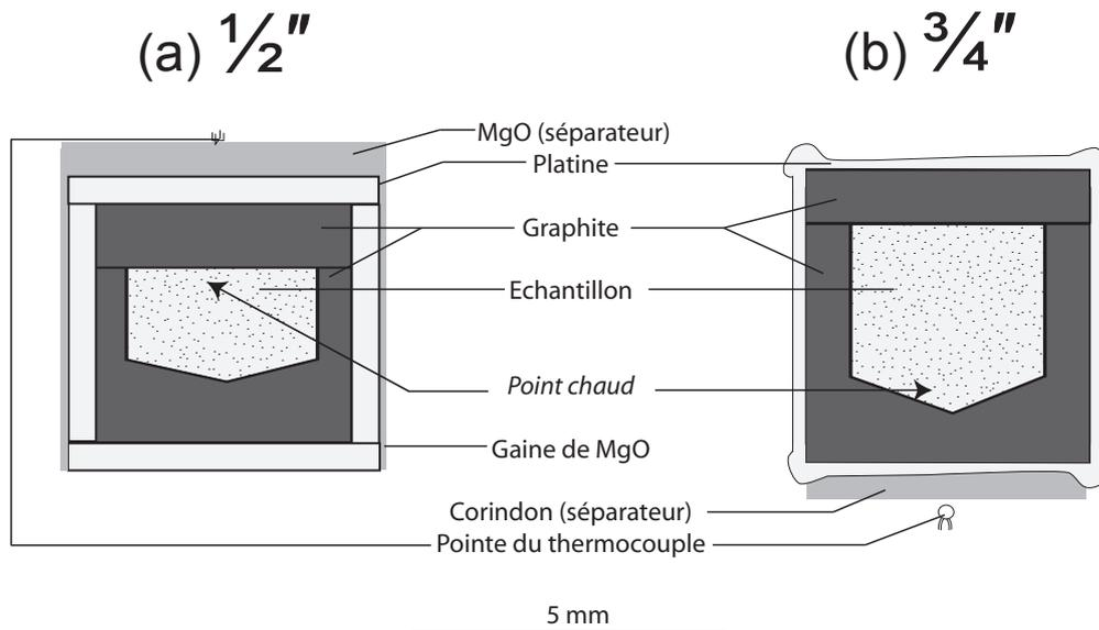
**Figure II.1** Géométries des capsules platine-graphite utilisées : (a) pour le piston-cylindre 1/2" et (b) pour le piston-cylindre 3/4". Notez la différence de position de la pointe du thermocouple entre les deux configurations : au dessus de la capsule en piston-cylindre 1/2" ; sous la capsule en piston-cylindre 3/4".
