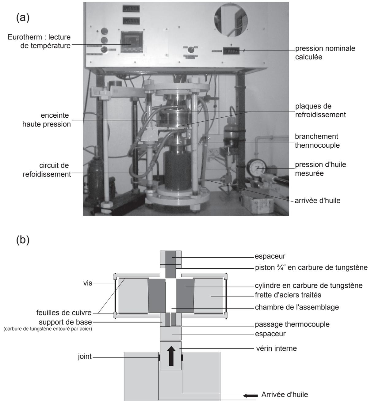
**Figure II.4** Photographie légendée (a) et schéma (b) d'un piston-cylindre 3/4" sans contre-pression du Laboratoire Magmas et Volcans. L'assemblage est placé dans le cylindre de carbure de tungstène. La pression est générée en écrasant l'assemblage entre le piston et le support de base.
