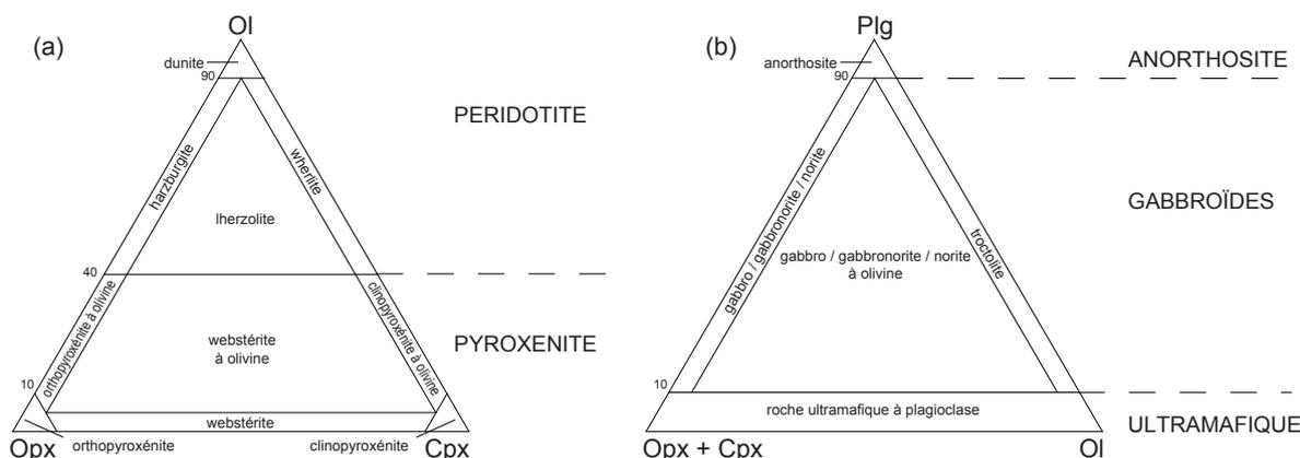
**Figure III.1** Classification de Streckeisen (1976) **(a)** des roches ultramafiques et **(b)** des roches gabbroïques. Dans les roches gabbroïques, un gabbro contient moins de 5 % d'opx, une norite contient moins de 5% de cpx et une gabbro-norite contient plus de 5% de chaque pyroxène.
