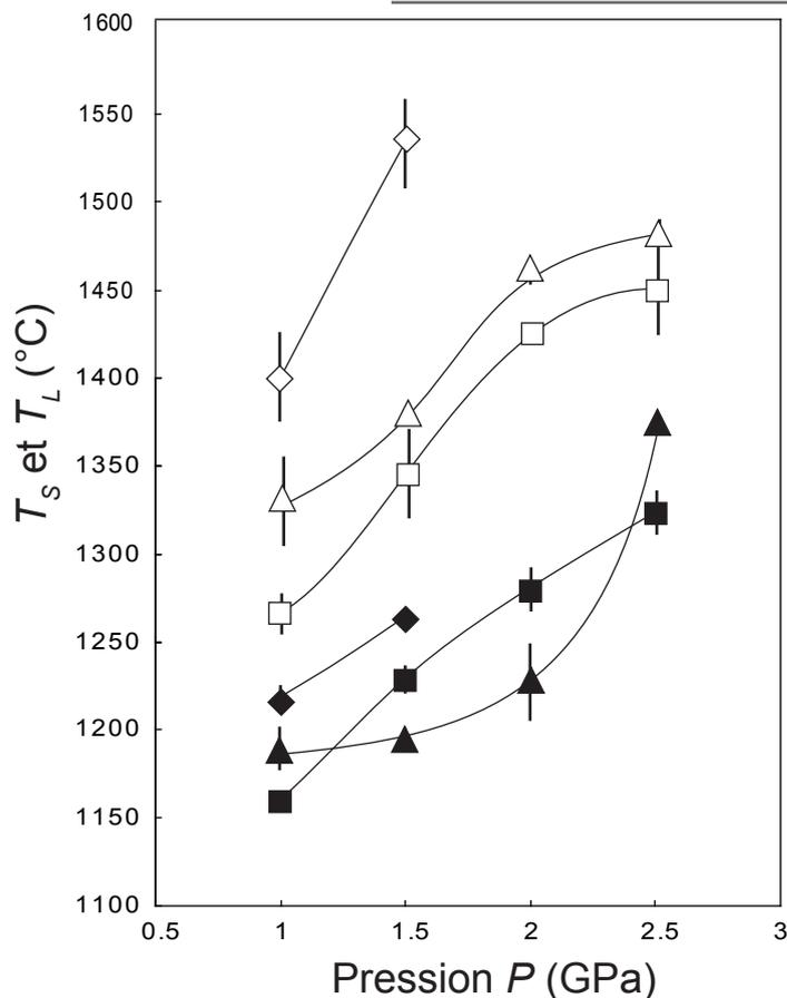
**Figure III.22** Températures de solidus ( $T_s$  – symboles pleins) et températures de liquidus ( $T_L$  – symboles ouverts) des pyroxénites M5-103 (losanges), M5-40 (triangles) et M7-16 (carrés) déterminées expérimentalement. L'erreur sur les  $T_L$  déterminées par extrapolation linéaire a été fixée à  $\pm 25^\circ\text{C}$ . Quand il n'y a pas de barre d'erreur, cette dernière est plus petite que le symbole.
