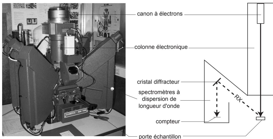
**Figure II.17** Photographie et schéma légendés d'une microsonde électronique Cameca SX100. Le faisceau d'électrons est canalisé et stabilisé dans la colonne électronique par plusieurs lentilles. Les lentilles à la sortie de la colonne permettent de déterminer la taille du faisceau sur l'échantillon. La zone excitée émet un spectre de Rayons X qui est caractéristique de sa composition ; le spectre est analysé par les 4 spectromètres.
