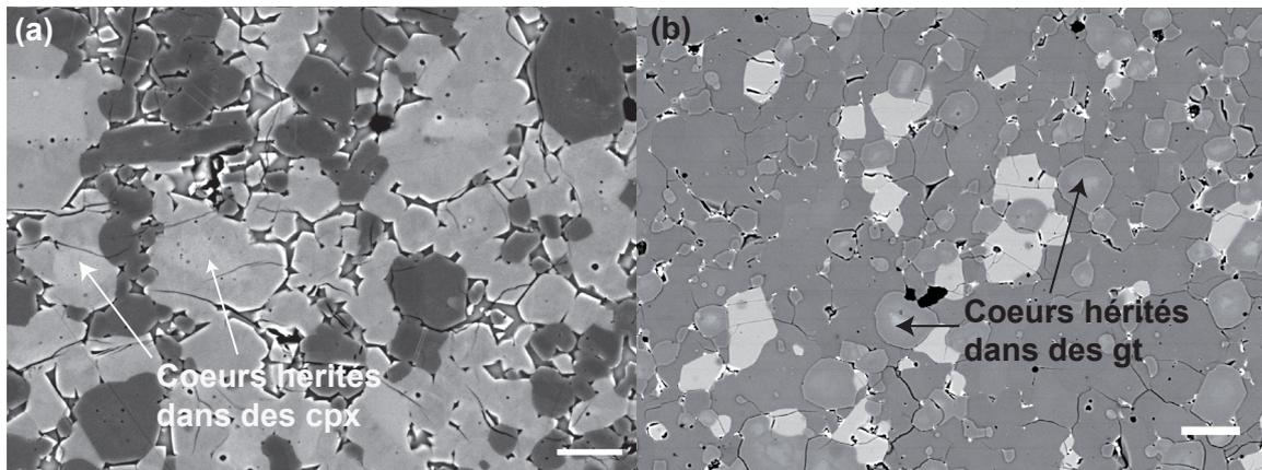
**Figure II.11** (a) Images MEB en électrons rétrodiffusés de l'expérience 103-B1 (1.0 GPa, 1250 °C, t = 88 h). Certains clinopyroxènes (cpx) contiennent des cœurs hérités. (b) Images MEB en électrons rétrodiffusés de l'expérience 16-A3 (2.0 GPa, 1330 °C, t = 118 h). Les grenats (gt) contiennent des cœurs hérités. Barres d'échelle : 20  $\mu\text{m}$ .
