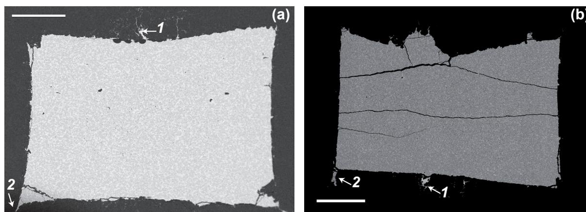
**Figure II.14** Images MEB en électrons rétrodiffusés de sections longitudinales des échantillons (a) 103-H2 et (b) FM1. Les flèches (1) pointent vers les filons centraux contenant du verre, et les flèches (2) vers des « filons de coin » totalement cristallisés. Le conteneur en graphite en noir entoure la charge expérimentale. Barres d'échelle : 500  $\mu\text{m}$ .
