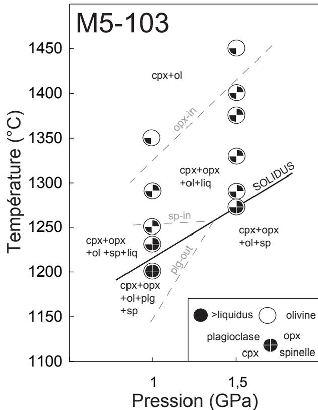
**Figure III.15** Diagramme de phases pour la composition M5-103 : données expérimentales ; ronds pleins : expériences superliquidus. Les lignes grises en pointillés correspondent à l'interprétation des limites de stabilité des phases
