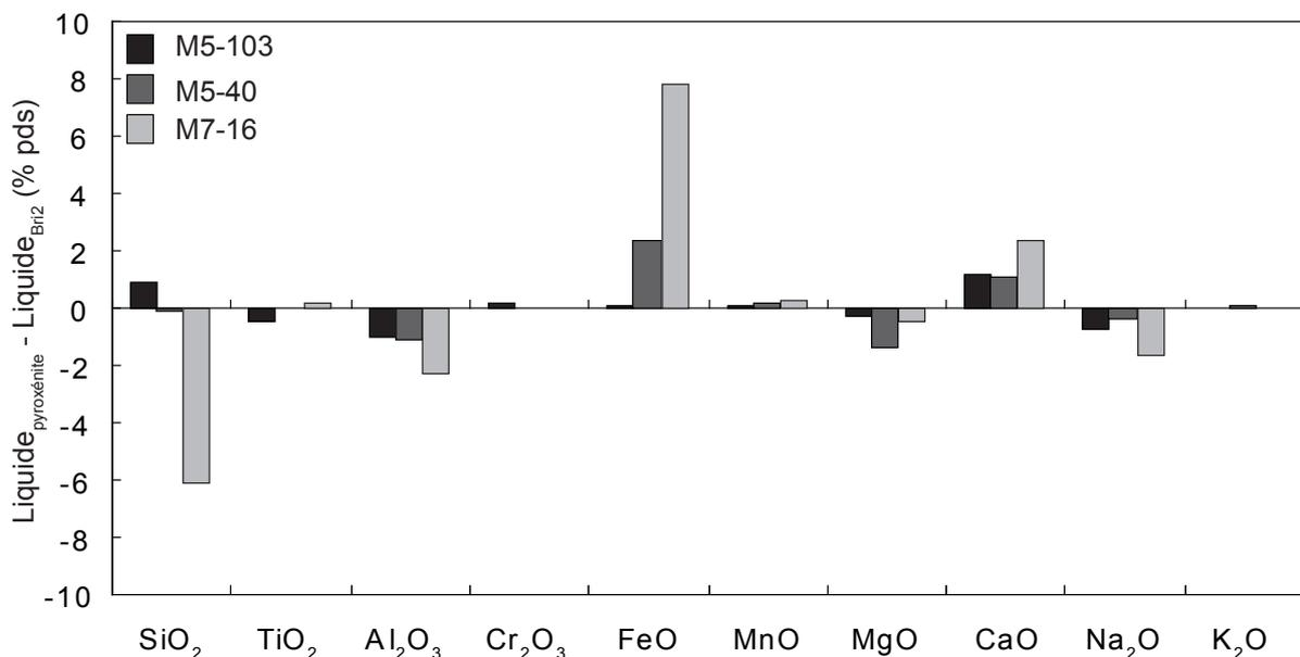
**Figure V.7** Différences de composition entre les liquides issus des pyroxénites M5-103 (noir), M5-40 (gris foncé) et M7-16 (gris clair) et le liquide issu de la péridotite Bri2 à 1 GPa et 1290°C. La composition du liquide de la péridotite a été déterminée avec pMELTS (Tableau V.1). Seul le liquide issu de M7-16 se distingue nettement du liquide de la péridotite par des teneurs en silice nettement plus basse (moins 6.5 % pds) et en FeO nettement plus élevée (plus 8 % pds).
