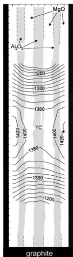
**Figure II.6** Variation de la température à l'intérieur du four en graphite dans un assemblage 3/4" ; cas d'une expérience réalisée à une température nominale de  $1400^\circ\text{C}$  (d'après Watson et al., 2002).
