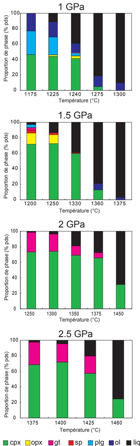
**Figure III.18** Evolution des proportions de phases en fonction de  $P$  et  $T$  dans la composition de départ M5-40. Couleurs : vert, cpx ; jaune, opx ; rouge, sp ; bleu clair, plg ; bleu foncé, ol ; noir, liquide ; rose, grenat..
