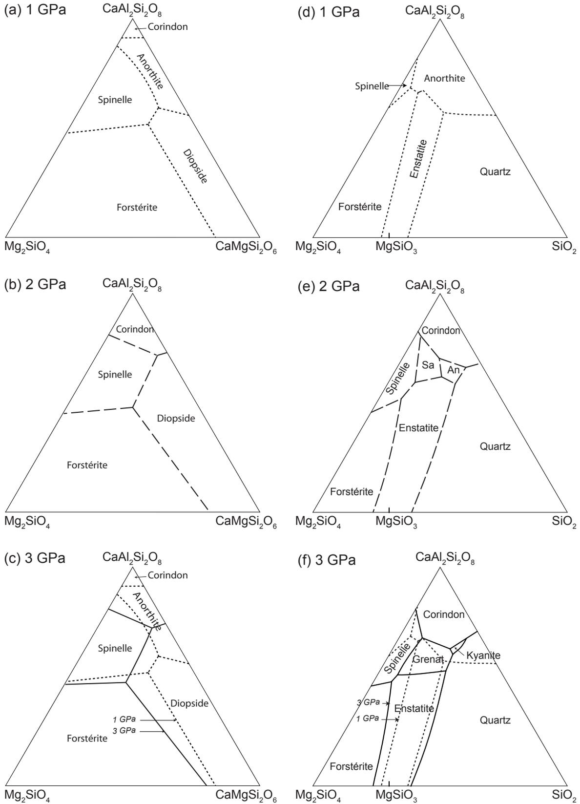
**Figure III.5** Comparaison des relations de phase liquidus à 1, 2 et 3 GPa (a-c) pour le joint Anorthite ( $\text{CaAl}_2\text{Si}_2\text{O}_8$ ) – Forstérite ( $\text{Mg}_2\text{SiO}_4$ ) – Diopside ( $\text{CaMgSi}_2\text{O}_6$ ) et (d-f) pour le joint Anorthite – Forstérite – Quartz ( $\text{SiO}_2$ ). Sa = saphirine, An = anorthite. Modifié d'après Presnall et al. (1978) et Milholland et Presnall (1998)
