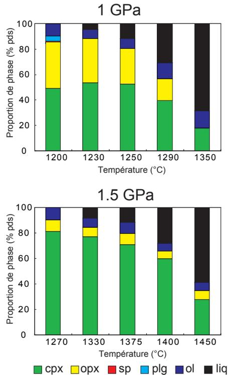
**Figure III.16** Evolution des proportions de phases en fonction de  $P$  et  $T$  dans la composition de départ M5-103. Couleurs : vert, cpx ; jaune, opx ; rouge, sp ; bleu clair, plg ; bleu foncé, ol ; noir, liquide.
