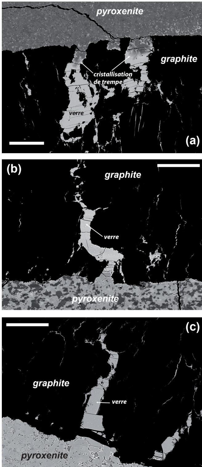
**Figure II.15** Images MEB en électrons rétrodiffusés de microdikes bien développés dans des expériences en 3/4". (a) 16-A2 : 1.5 GPa – 1250°C,  $F = 9.4$  % pds. ; (b) 103-H2b : 1.5 GPa – 1270°C,  $F = 2.6$  % pds. ; (c) 40-E2 : 1.5 GPa – 1250°C,  $F = 13.5$  % pds. Barres d'échelle : 100  $\mu\text{m}$ .
