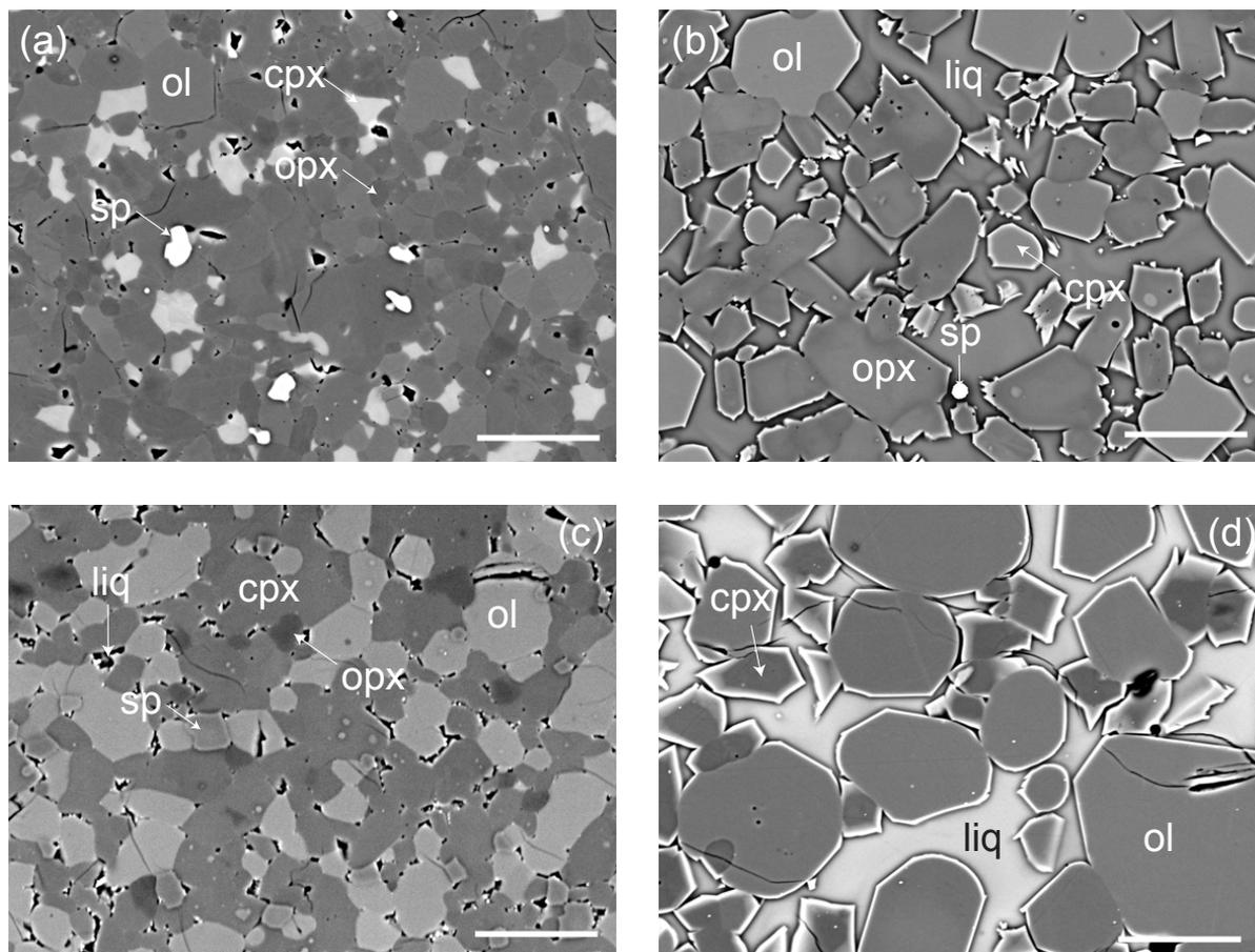
**Figure V.8** Images MEB en électrons rétrodiffusés illustrant les textures et les assemblages de phases des expériences de la série Inter. (a) Inter0, (b) Inter40, (c) Inter16 et (d) Inter16BP. Barres d'échelle : 20 µm.
