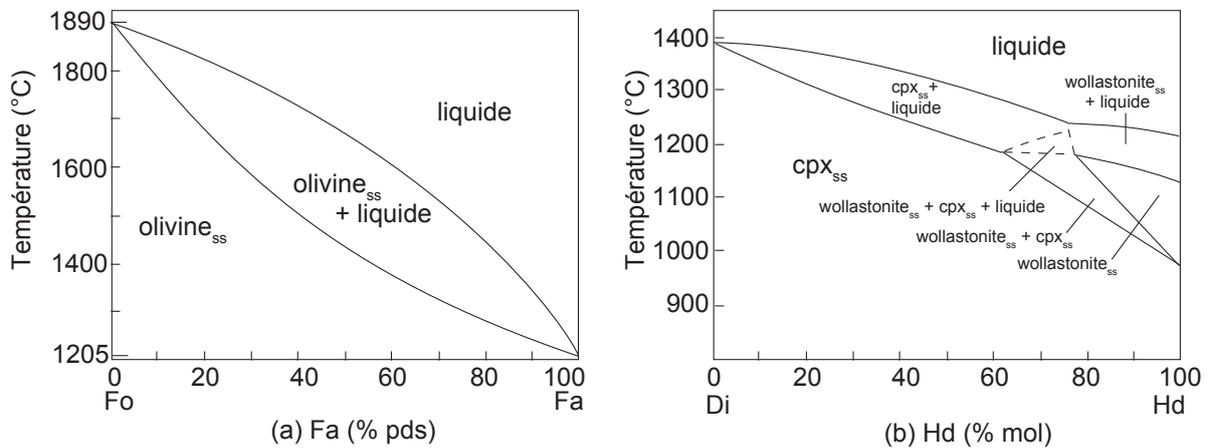
**Figure III.37** Domaines de stabilité des phases dans un diagramme température vs. composition à 1 atm pour les systèmes binaires (a) Forstérite ( $\text{Fo} - \text{Mg}_2\text{SiO}_4$ ) – Fayalite ( $\text{Fa} - \text{Fe}_2\text{SiO}_4$ ), d'après Bowen et Schairer (1935) et (b) Diopside ( $\text{Di} - \text{CaMgSi}_2\text{O}_6$ ) – Hedenbergite ( $\text{Hd} - \text{CaFeSi}_2\text{O}_6$ ), d'après Schairer et Yoder (1962). ss = solution solide.
