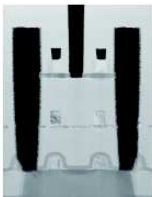
Figure 4.15 Observation TEM d'une coupe de SRAM empilée sur 3 niveaux [Jung07]
